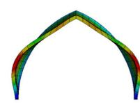
Fig. 4: Bóveda ojival rebajada y deformada.
