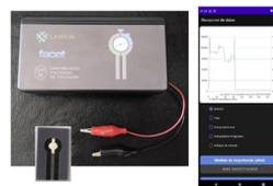
Fig. 2 Dispositivo desarrollado. Celda de papel con electrodos de carbono serigrafados. Pantalla del programa en dispositivo Android
