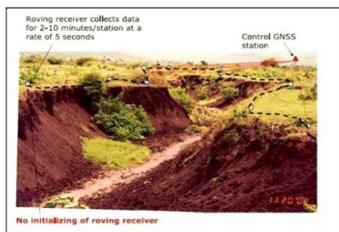
**Fig. 2.** Red de trilateración para el monitoreo de la extensión de la erosión utilizando posicionamiento estático-rápido. Nota: Los triángulos representan estaciones de control mientras que los círculos indican las posiciones ocupadas por el receptor móvil (método "stop and go"). [1].
