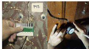
Fig. 6: Medición de fisuras.
