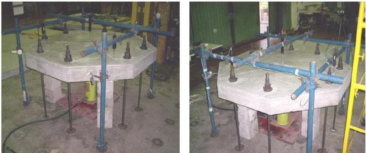
Figura 5.3: Montaje de las losas para su ensayo experimental (Isla, 2008).
