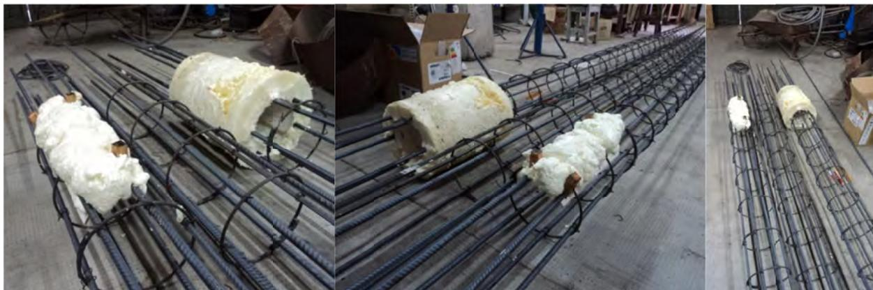
**Figura A.5:** Armaduras con y sin defectos.
