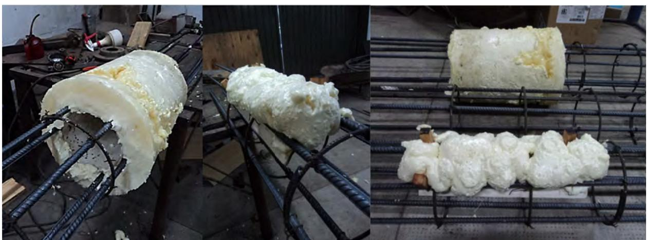
**Figura A.4:** Materialización de los defectos.
