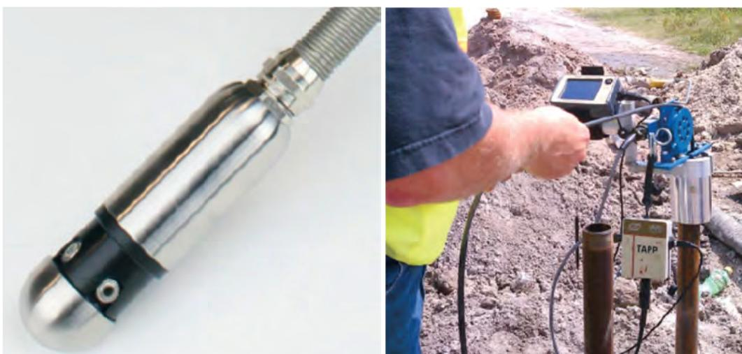
**Figura 2.12:** Sonda térmica (izquierda) y equipamiento para el ensayo (derecha).
