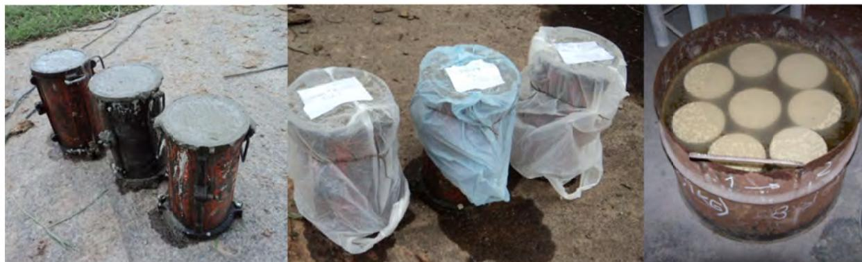
**Figura B.1:** Moldeo y curado de las probetas.
