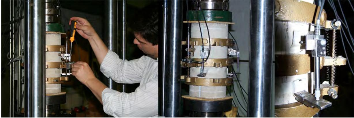
Figura B.3: Instrumentos para la medición de desplazamientos.
