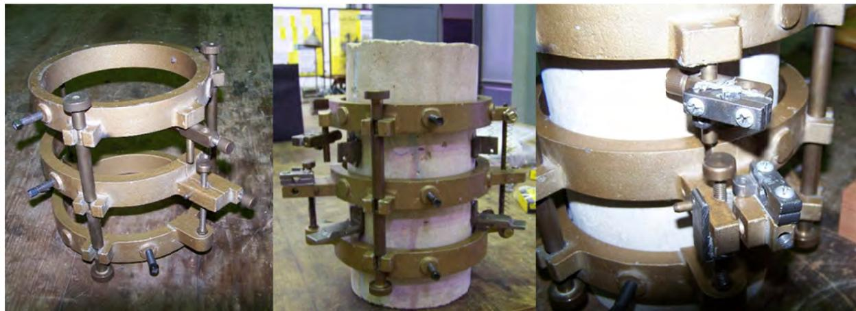
**Figura B.2:** Combinación compresómetro - extensómetro.
