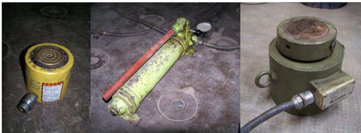
Figura B.11: Gato, bomba hidráulica y celda de carga,.
