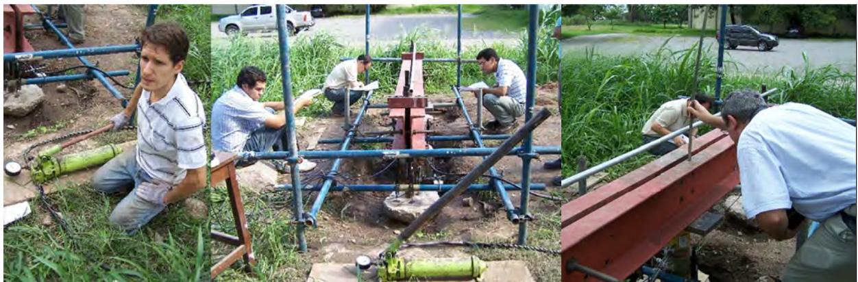
**Figura B.17:** Aplicación de la carga y lectura de las deformaciones.
