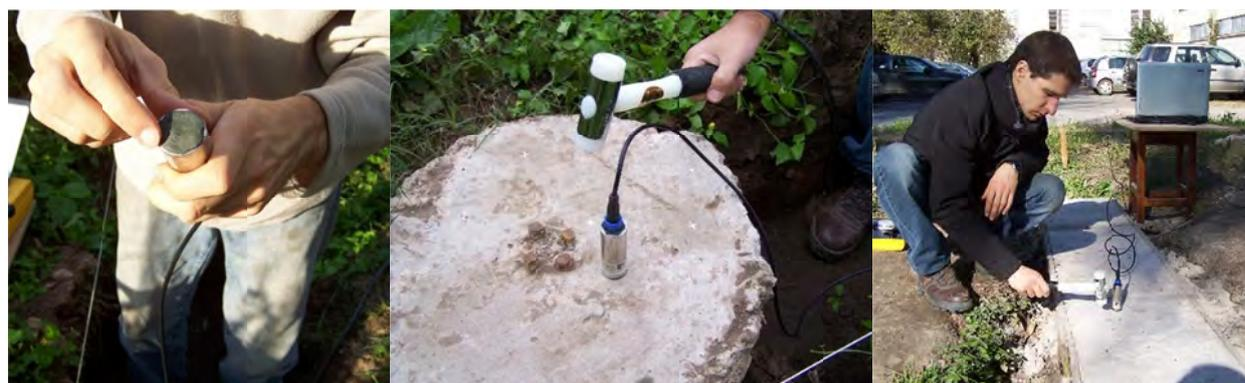
Figura 4.9: Pruebas con el equipo PILETEST.
