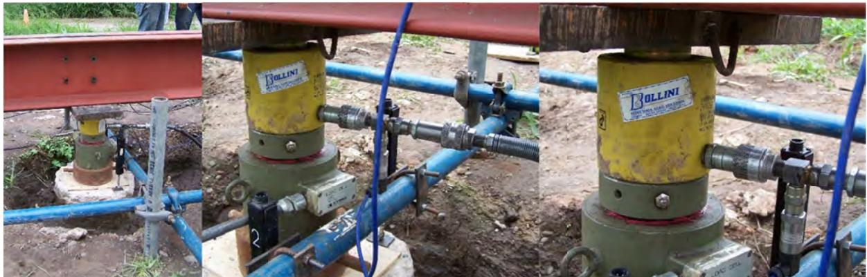
Figura B.13: Celda y gato ubicados en posición.
