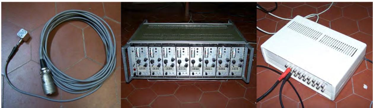
**Figura 4.6:** Acelerómetro (izquierda), amplificador (centro) y placa de adquisición de datos (derecha).
