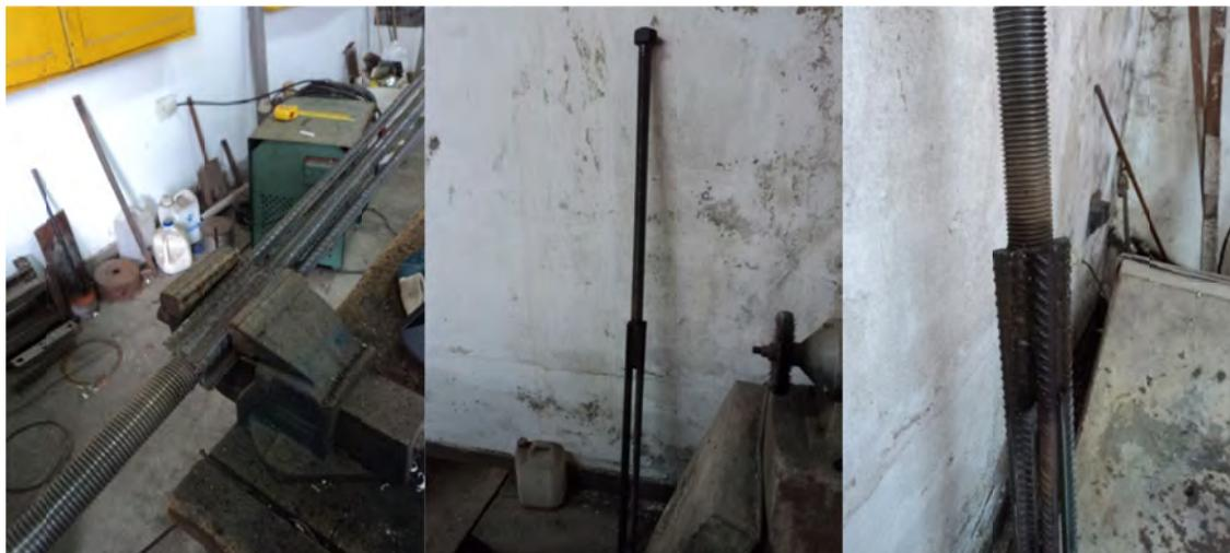
**Figura A.7:** Varillas roscadas con sus anclajes.
