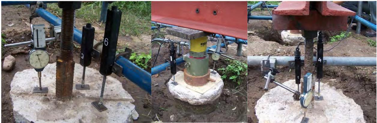
**Figura B.16:** Instrumentos de medición.
