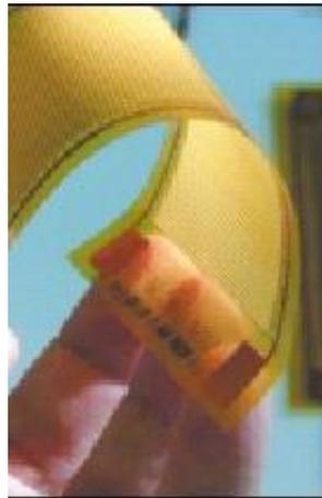
Figura 2.11: Parche de compuesto piezoeléctrico polarizado con electrodos interdigitales ([Smart-Material, 2010](#)).
