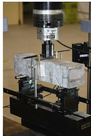
Figura 5.45 – Esquema de la viga y configuración del ensayo mediante prensa hidráulica (Zhang et al, 2009)
