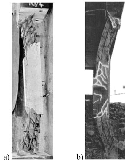
Figura 2.16 – Ensayos a escala real en columnas de hormigón armado sometidas a explosiones:
