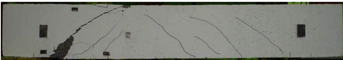
Figura 4.9. Viga 6 sin refuerzo. Cuadro de fisuración lado izquierdo. Banda de fisuras diagonal.
