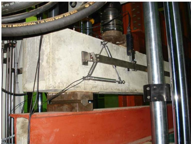
Figura 3.24. Viga instrumentada, en posición y lista para ensayar.
