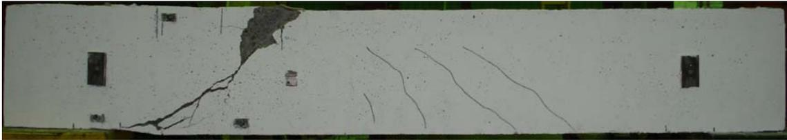
Figura 4.7. Viga 10 sin refuerzo. Cuadro de fisuración lado izquierdo. Fisura diagonal marcada.
