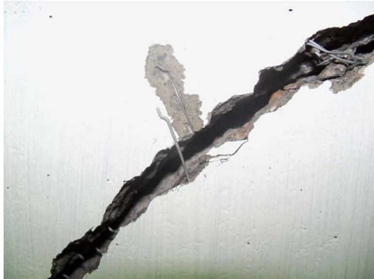
Figura 4.45. Movimiento relativo entre bloques de viga 23 sin estribos reforzada con HRF 30kg/m<sup>3</sup>. La fibra superficial provoca estallido del recubrimiento y evidencia el desplazamiento entre las caras de la fisura.
