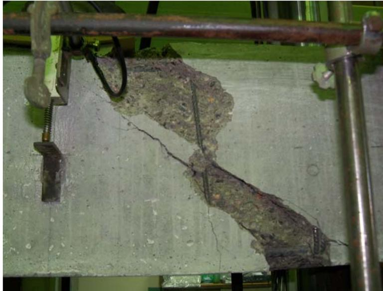
Figura 4.1. Viga piloto 1 sin refuerzo. Estado final.
