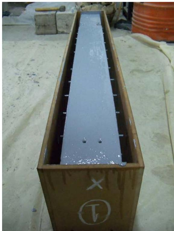
Figura 3.18. Viga piloto con puente de adherencia dentro de molde.
