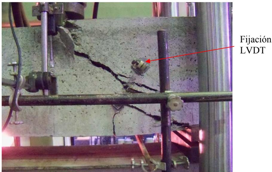
Figura 4.6. Estado final viga piloto 2 reparada.
