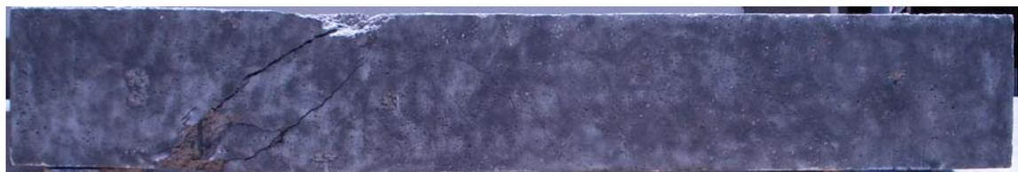
Figura 3.15. Estado previo a la reparación de viga 6 cara izquierda.
