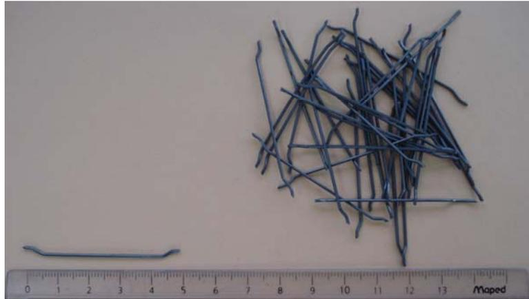
Figura 3.6. Fibras de acero  $l=50\text{mm}$ ,  $d=1\text{mm}$  con ganchos.
