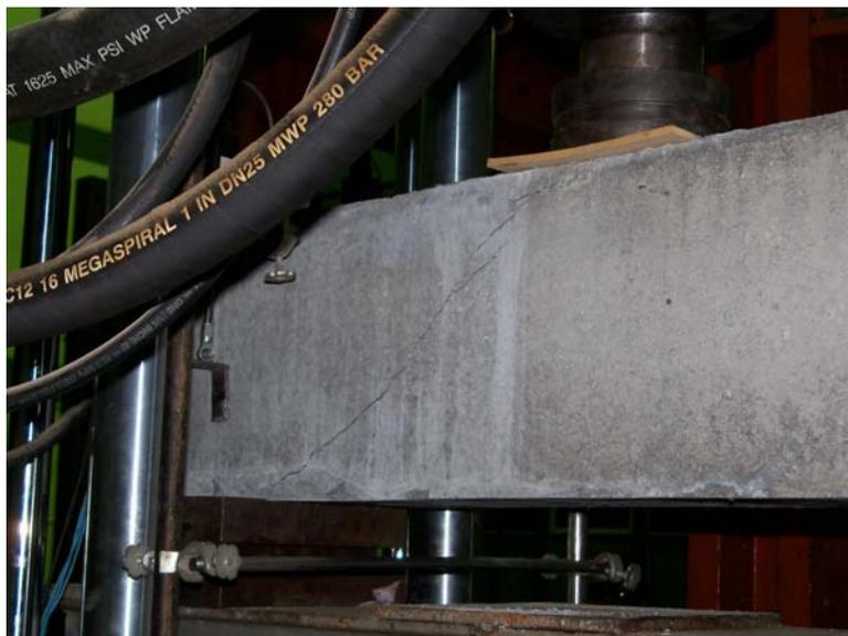
Figura 4.2. Viga piloto 2 sin refuerzo. Estado final.
