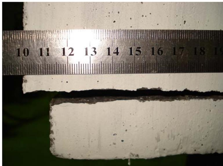
Figura 4.16. Desplazamiento hormigón de recubrimiento lado izquierdo viga 14 reparada con hormigón sin fibras.
