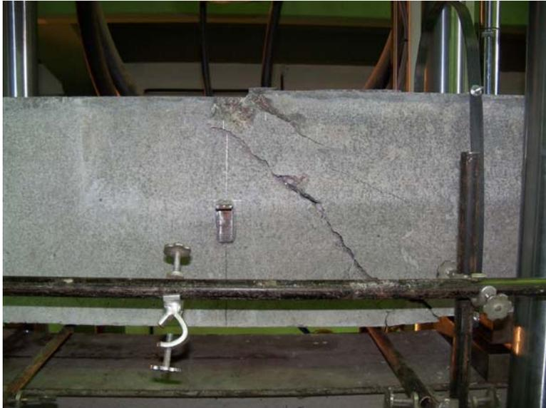
Figura 4.5. Estado final viga piloto 1 reparada.
