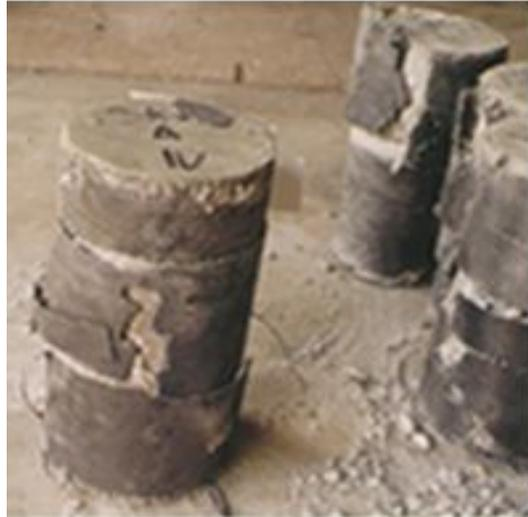
Figura 2.22. Modo de falla típico de una probeta confinada con CFRP
