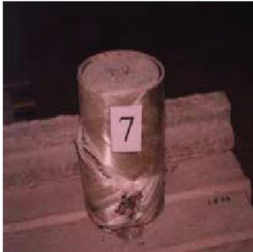
Figura 2.23. Modo de falla de una probeta confinada con GFRP
