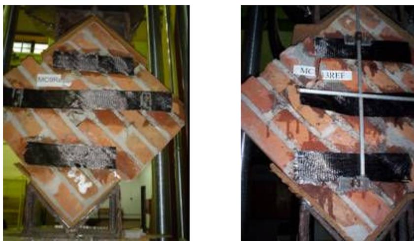
Figura 4.25. Tipos de rotura.
