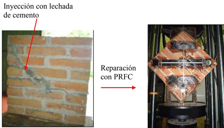
Figura 4.27. Esquema de reparación con bandas unidireccionales de PRFC dispuestas ortogonalmente a la dirección de aplicación de la carga.
