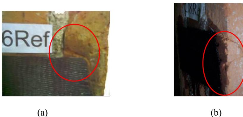
Figura 4.38. Tipos de rotura: (a) Espécimen reforzado, (b) Espécimen reparado con bandas PRFC.
