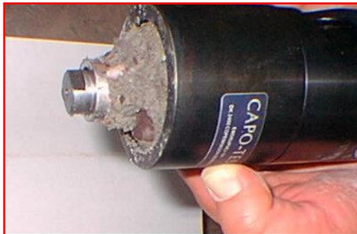
Fotografía N° 12: Detalle del inserto extraído con el trozo de hormigón
