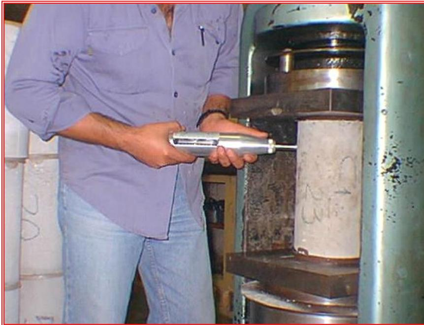
**Fotografía N° 3: Determinación del número de rebote en probetas**
