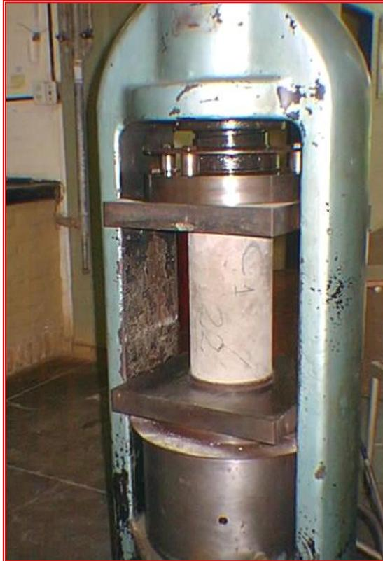
**Fotografía N° 14: Ensayo a compresión de probetas de 15 cm por 30 cm**
