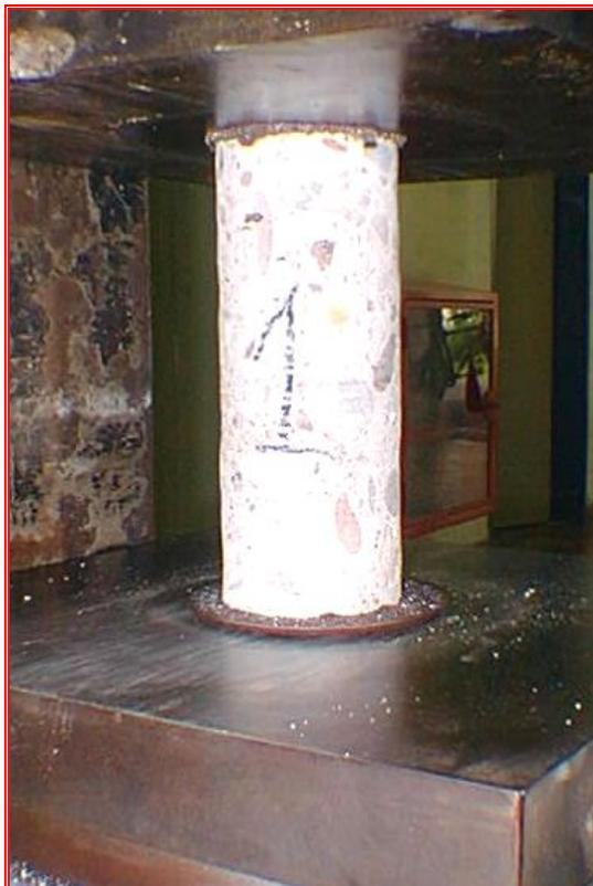
**Fotografía N° 15: Ensayo a compresión de testigos**
