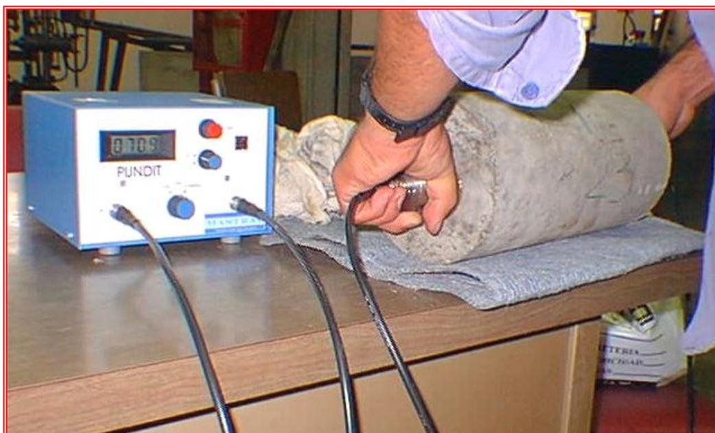
**Fotografía N° 1: Determinación del tiempo de pasaje del pulso ultrasónico en probetas**
