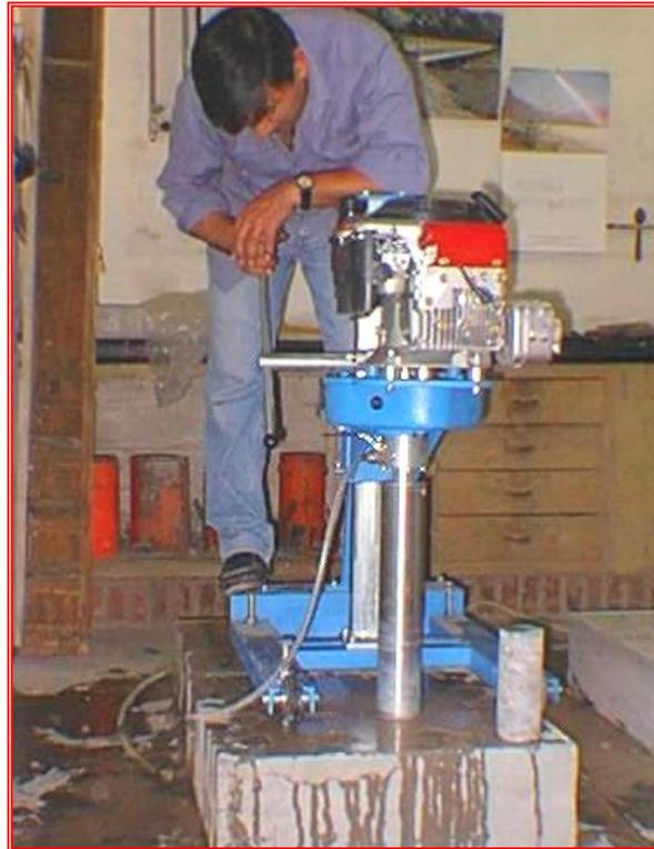
**Fotografía N° 13: Extracción de testigos**
