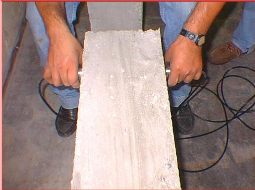
Fotografía N° 2: Determinación del tiempo de pasaje del pulso ultrasónico en placas
