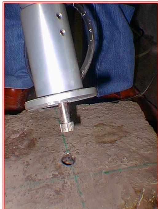
**Fotografía N° 6: Ensanchamiento de la perforación**
