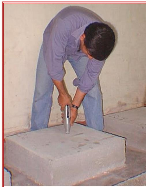
**Fotografía N° 4: Determinación del número de rebote en placas**
