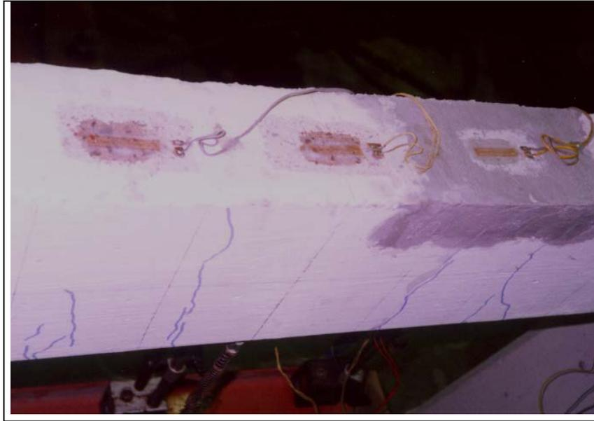
Figura 6.15. Estado final de extensómetros en hormigón
