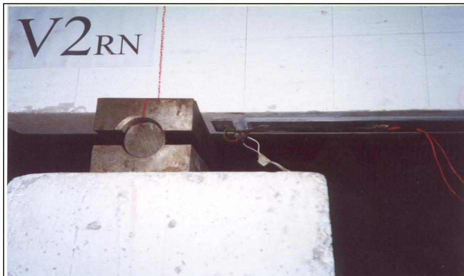
*Figura 7.2. Apoyos de las vigas ensayadas.*
