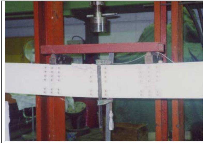
*Figura 7.1. Sistema de transmisión de carga*
