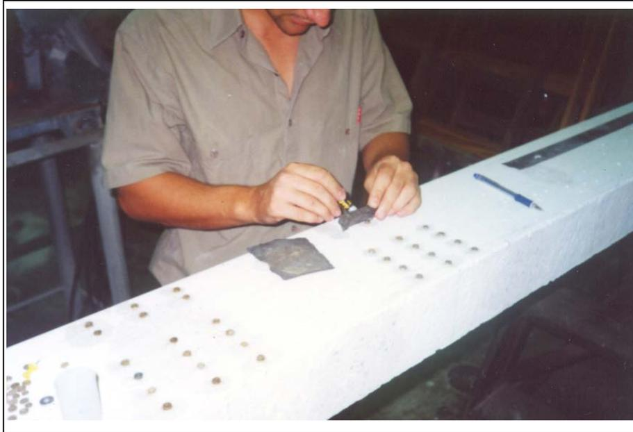
*Figura 6.16. Pegado de discos metálicas.*
