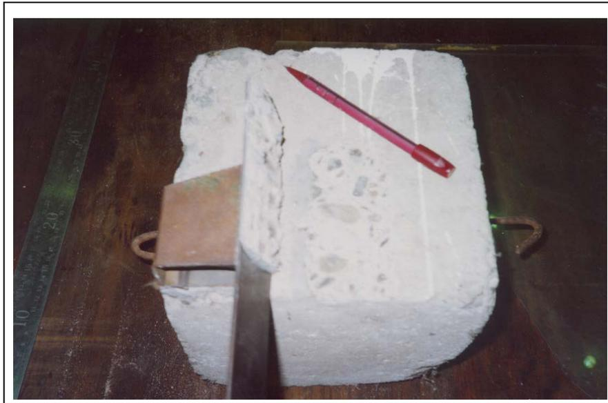
*Figura 6.8. Ensayos de resistencia de pegamento epoxi.*
