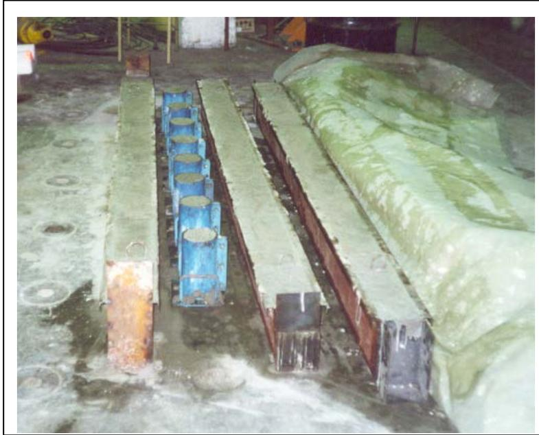
*Figura 6.13. Curado de vigas y probetas*
