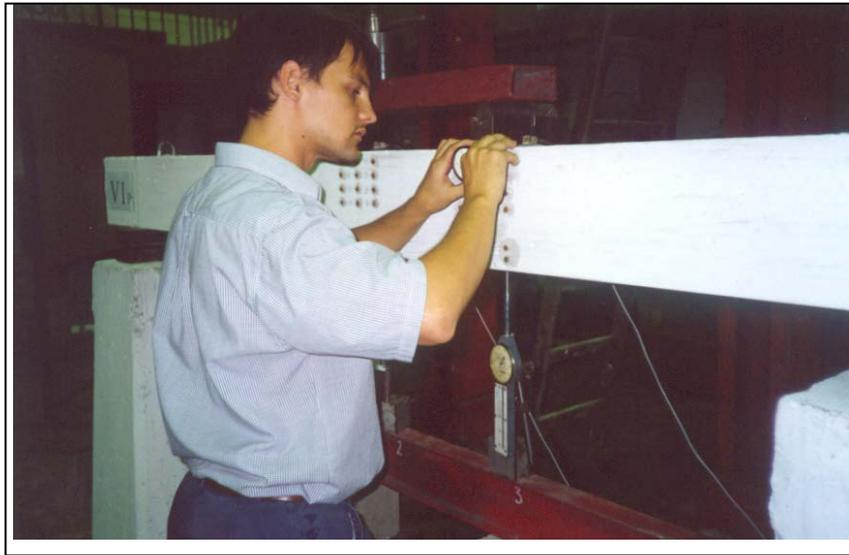
*Figura 7.6. Medición de deformaciones entre discos metálicos con DEMEC*
