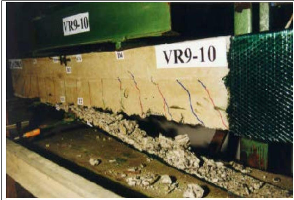
*Figura 1.2 – Modo de Falla Local: Peel-off*
