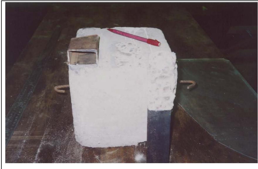
*Figuras 6.7. Ensayos de resistencia de pegamento epoxi.*
