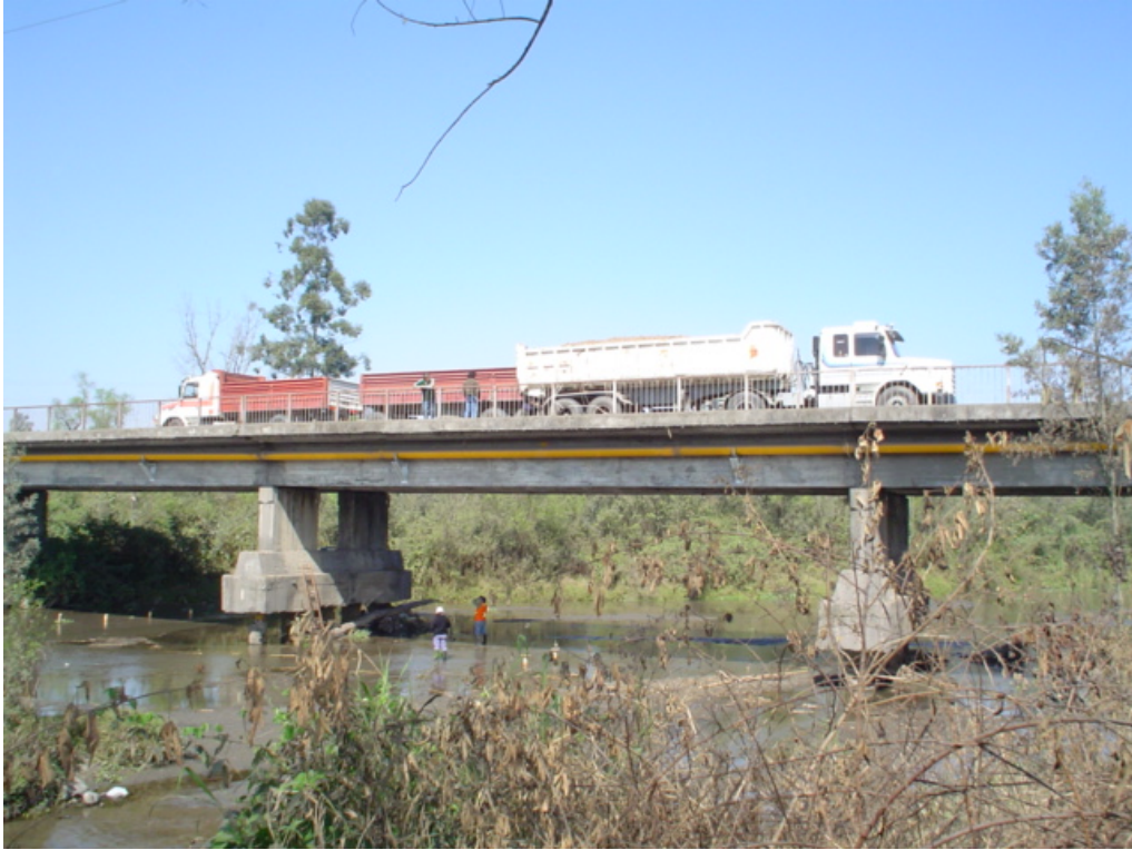
Fotografía 5.3: Segundo estado de carga con dos camiones
