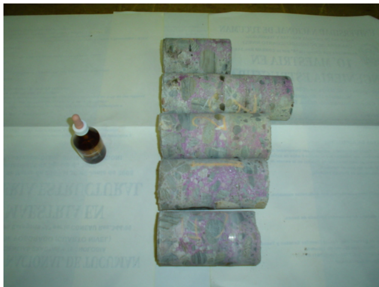
Fotografía 3.31: Determinación de la profundidad de carbonatación
