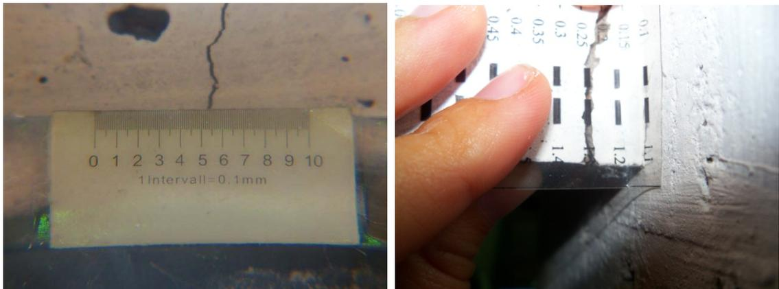
**Figura 4.23** Medición de fisuras
