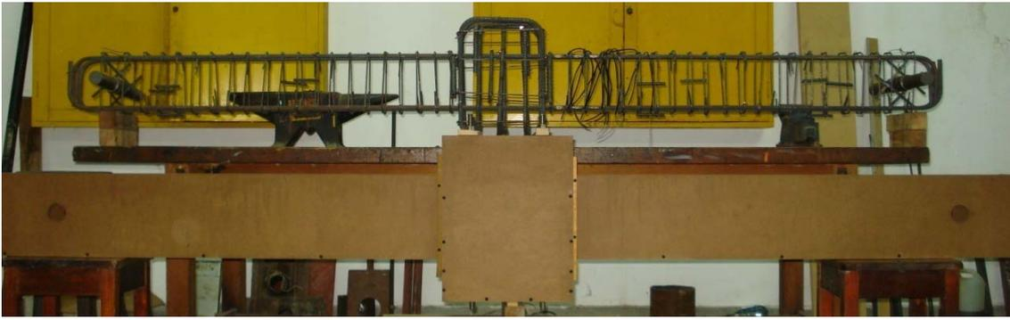
**Figura 4.12** Detalle constructivo armadura y encofrado del espécimen
