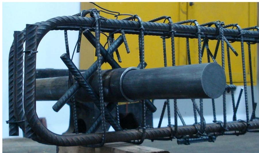
**Figura 4.11** Detalle constructivo apoyo articulado
