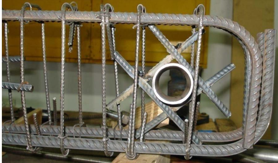
**Figura 4.10** Detalle constructivo del apoyo articulado
