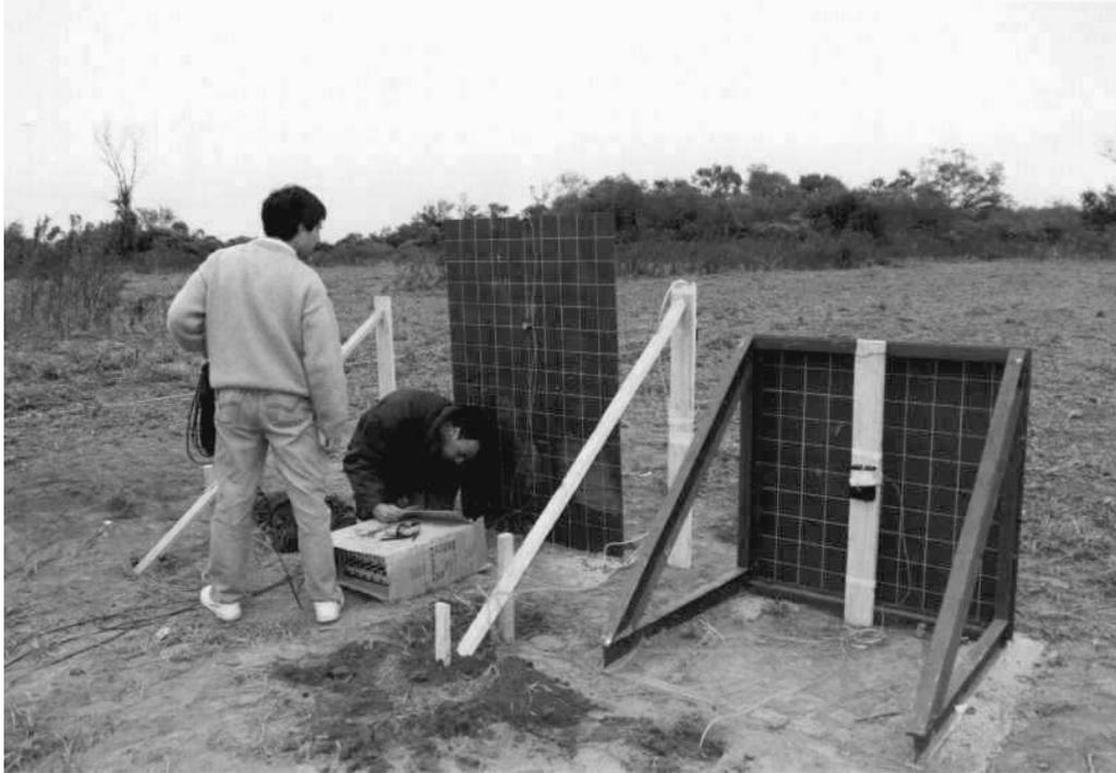
Figura 3.2. Vista general de la disposición de las placas metálicas.
