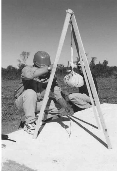
Figura 3.8. Disposición de la carga explosiva sobre la losa.
