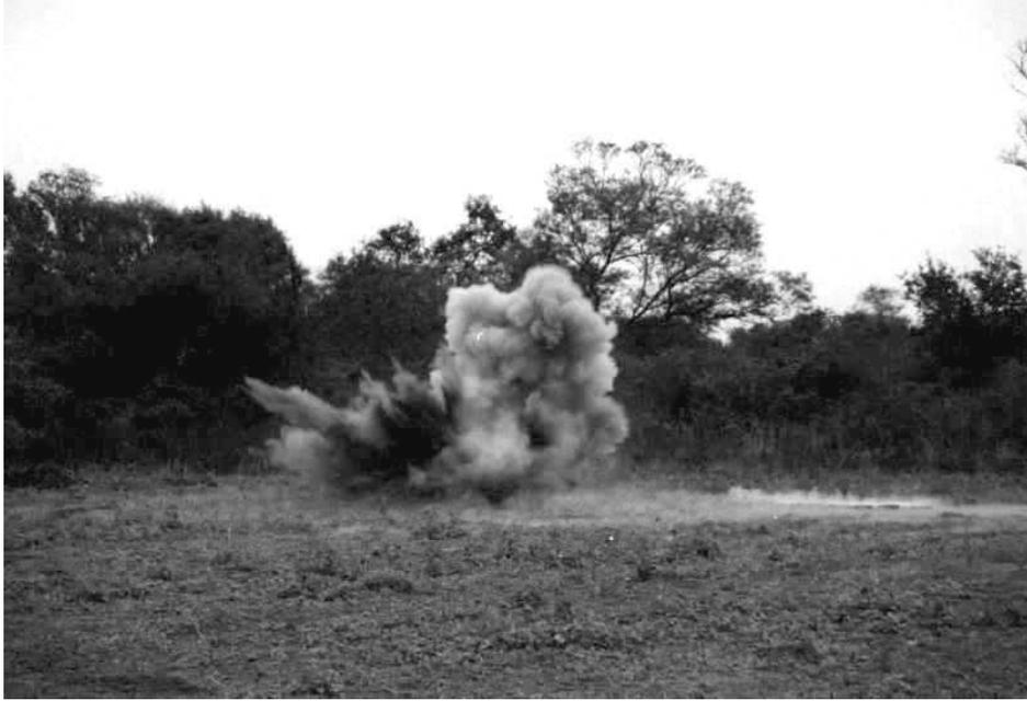
Figura 3.12. Explosión de la carga de 0.8 Kg de TNT.
