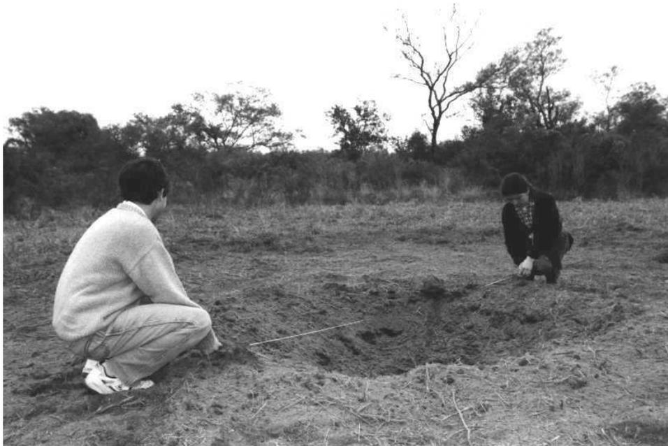
Figura 3.26. Determinación del diámetro aparente del cráter.
