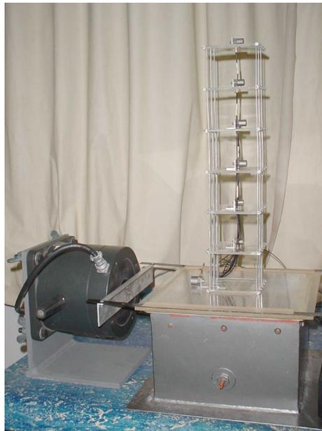
**Figura 5.6. Modelo ensayado en mesa vibratoria**
