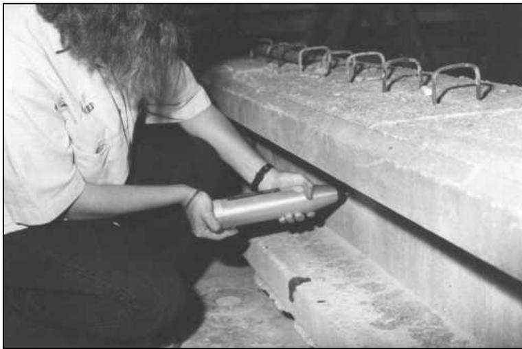
**Fotografía V-5: Esclerómetro**
