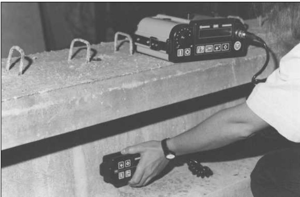
**Fotografía V-4: Sonda Electromagnética**
