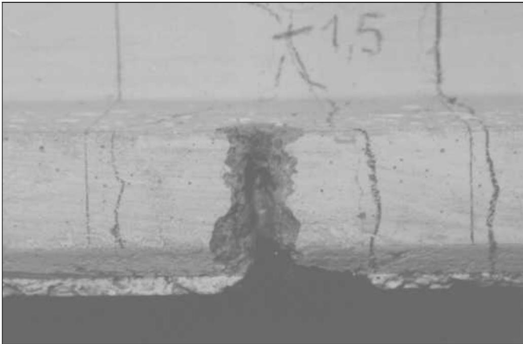
**Fotografía VI-14: Reducción Del 50% De La Armadura. Corte De Las Trenzas Superiores.**
