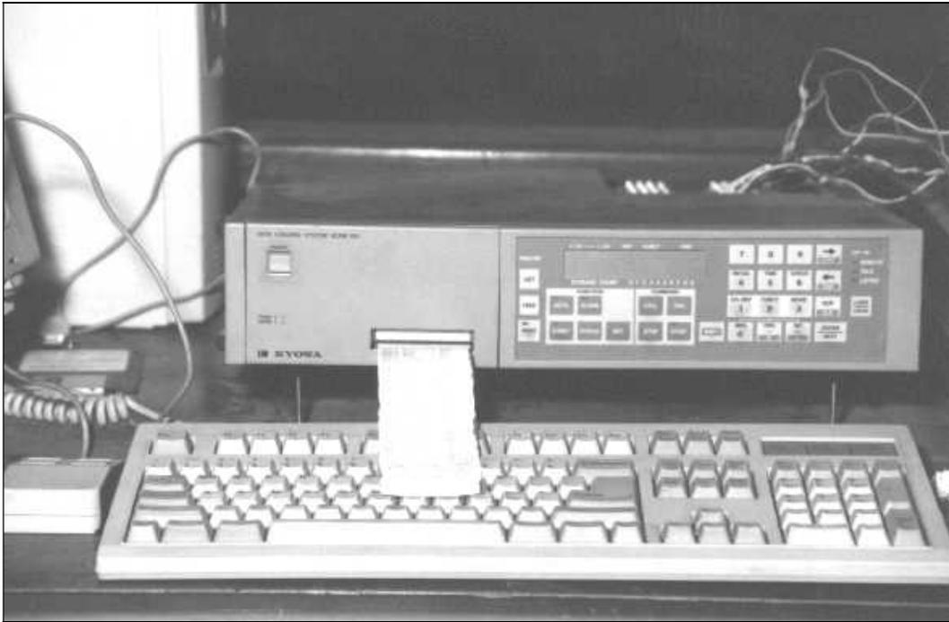
**Fotografía VI-3: Adquisidor De Datos ( UCAM - 10A)**
