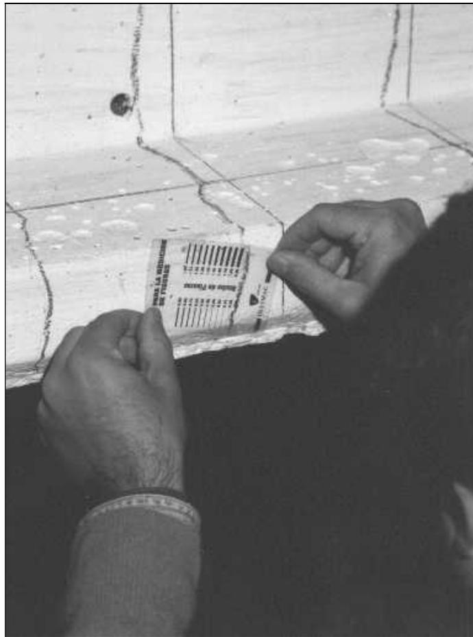
**Figura VI-16: Trazado y Medición De Las Fisuras**
