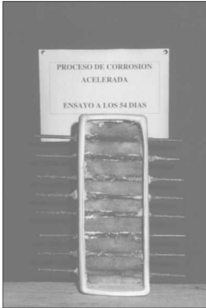
**Fotografía III-3: Proceso Corrosivo A Los 54 Días Del Ensayo**
