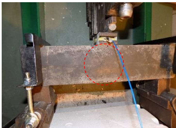
Figura 3.10: Viga de hormigón simple, velocidad de impacto de 1.42 mm/ms ( H = 132 mm).
