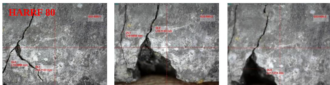
Figura A3.3.7 Viga de HARRF G33, velocidad de impacto de 3.00 mm/ms (H = 500 mm).
