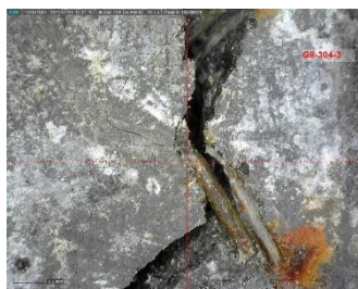
Figura A3.3.2: Viga de HARRF G8, velocidad de impacto de 2.31 mm/ms (H = 304 mm).
