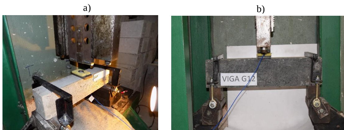
Figura 3.5: Montaje del anillo de fuerza sobre las vigas a) Vista de perfil b) vista frontal.
