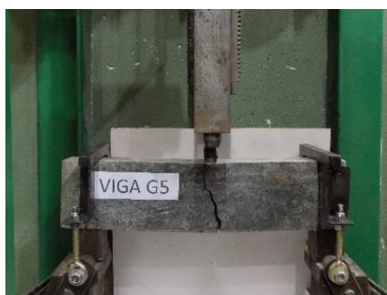
Figura 3.12: Viga de hormigón simple, velocidad de impacto de 2.31 mm/ms ( H = 304 mm)
