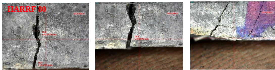
Figura A3.3.6 Viga de HARRF G13, velocidad de impacto de 3.00 mm/ms (H = 500 mm).
