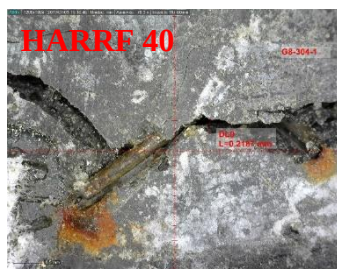
Figura A3.3.2: Viga de HARRF G8, velocidad de impacto de 2.31 mm/ms (H = 304 mm).
