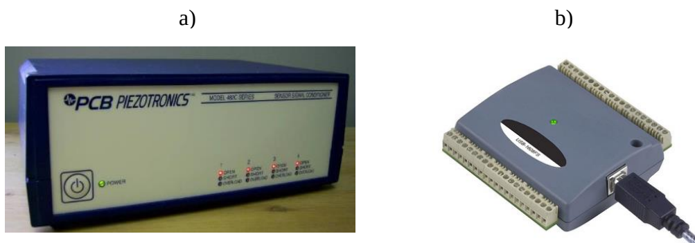
Figura 3.8: Equipo empleado para la adquisición de señales a) Acondicionador de señales PCB 482C05 b) placa de adquisición USB-1608FS.
