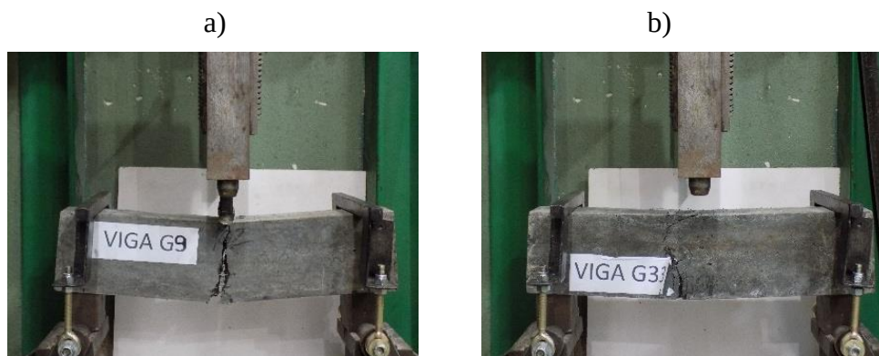
Figura 3.13: Vigas de HARRF después de ser ensayadas a una velocidad de impacto de 4.21 mm/ms ( H = 1000 mm). a) Viga de HARRF con 40 \text{ kg/m}^3 de fibras, b) Viga de HARRF con 80 \text{ kg/m}^3 de fibras.
