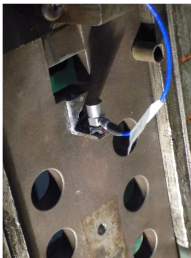
Figura 3.7: Montaje de los acelerómetros sobre el proyectil.
