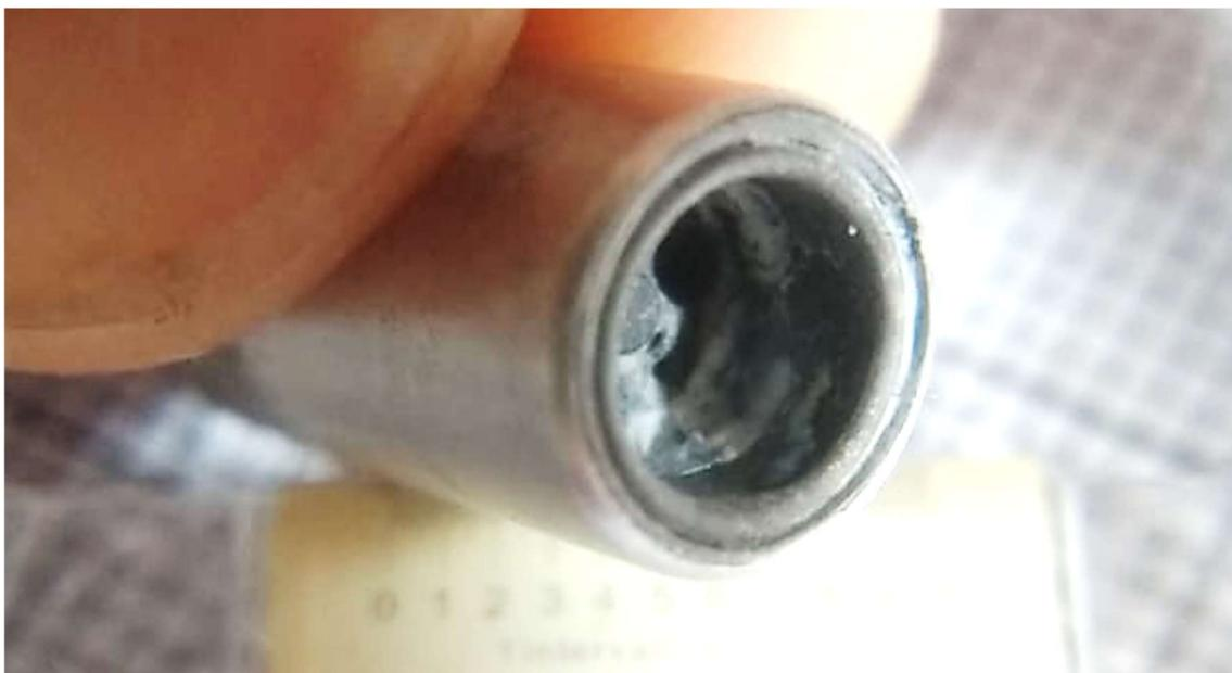
Fig. 185 - Sedimentación en el cuerpo de la placa perforada
