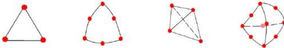
Fig. 58 - Elementos de superficie (izquierda) y tipos de elementos de sólidos (derecha)
