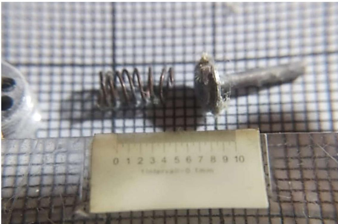
Fig. 186 - Cuerpos interiores afectados por la sedimentación
