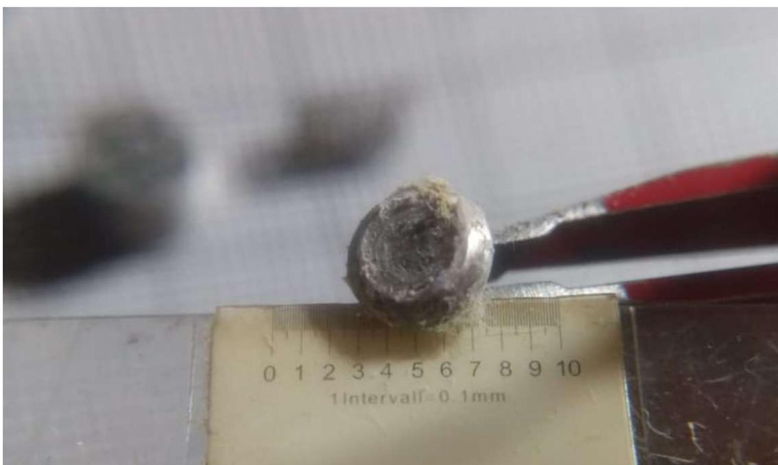
Fig. 187 - Pistón con material de sello (silicona) desgastada.
