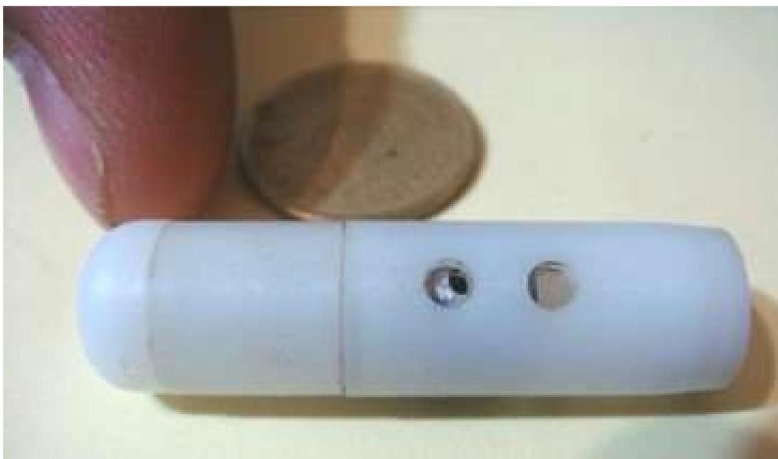
Fig. 35 - MVI fabricada por microfresado en grilón
