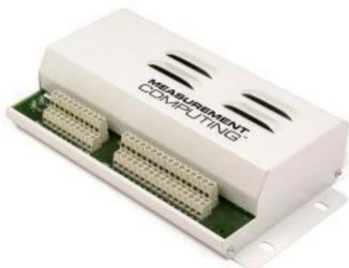
Figura 5.16: Placa de adquisición USB-1616FS
