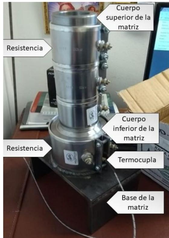
Figura 5.4: Cuerpo de la matriz con la resistencia, resistencias suncho y termocuplas.
