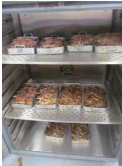
Figura 3.7: Determinación de humedad para astillas (izquierda) y biomasa molida (derecha) (Ortiz, 2006; Vega y Ortiz, 2013).
