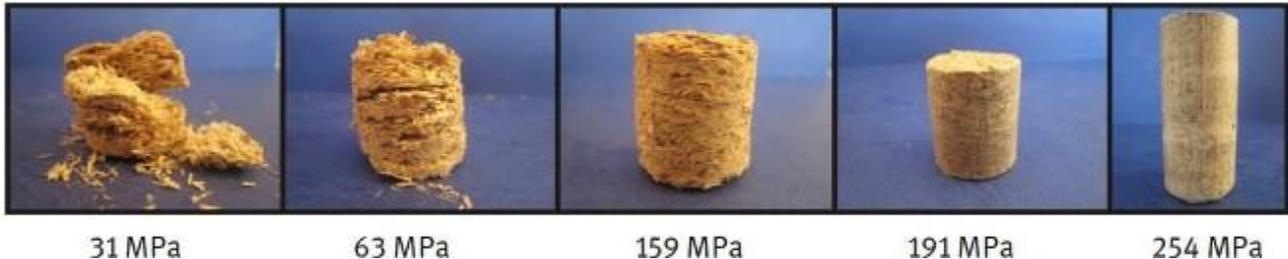
Figura 4.27: Briquetas con conformadas a diferentes presiones (Križan, Šooš y Vukelić, 2008).
