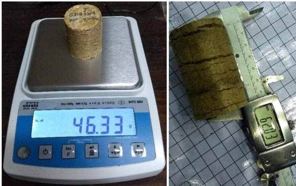
Figura 5.23: Determinación de la densidad (masa y volumen)
