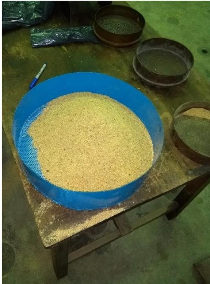
Figura 5.13: Tamices calibrados para la separación de biomasa
