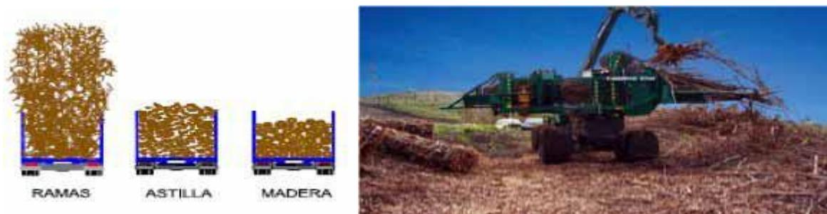
Figura 3.10: La baja densidad aparente de biomasa residual y astillas resulta en altos costes de transporte. Derecha: compactación de biomasa en pacas mediante empacadora forestal (Sanz Piñeiro et al., 2011).
