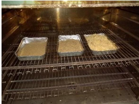
Figura 5.20: Secado en horno de las diferentes muestras de biomasa
