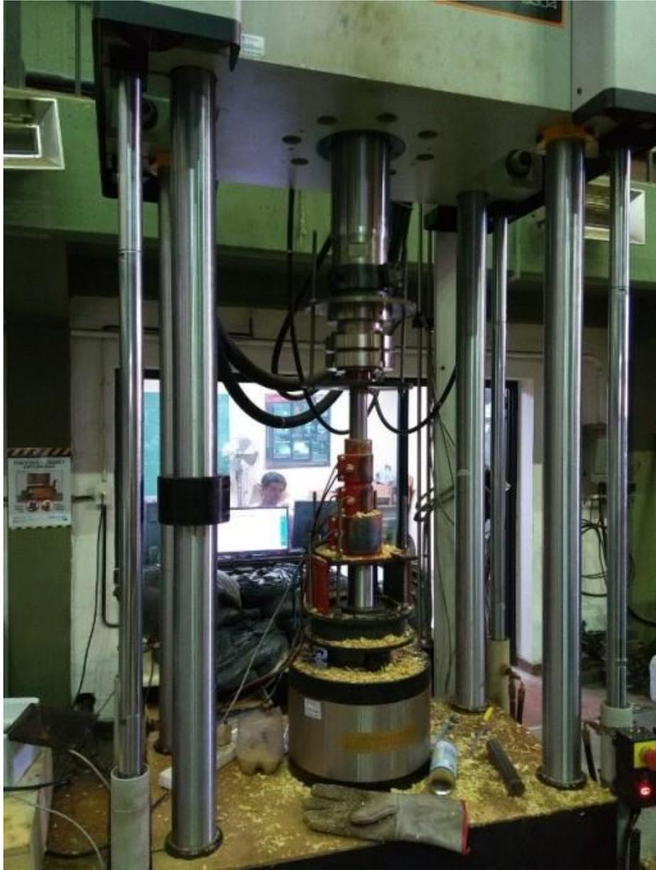
Figura 5.9: Prensa INSTRON 8800 con la matriz de fabricación de briquetas
