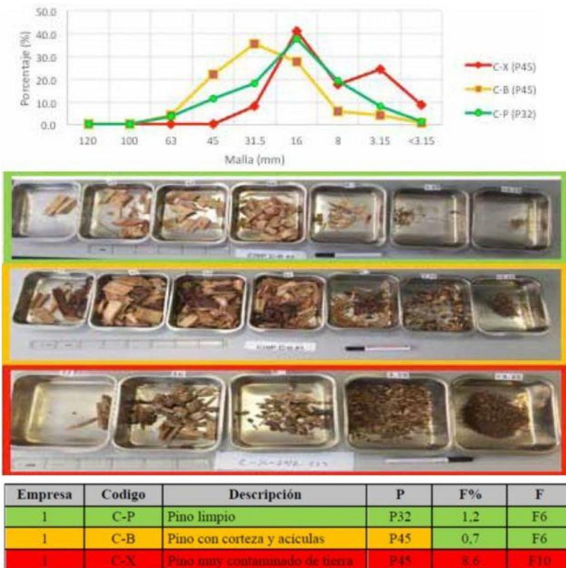
Figura 3.12: Control de calidad de la granulometría y contenido de finos de astillas de tres muestras (C-P,B y X) en una empresa consumidora de astilla para combustión en el Noroeste español (Somoza et al., 2014).
