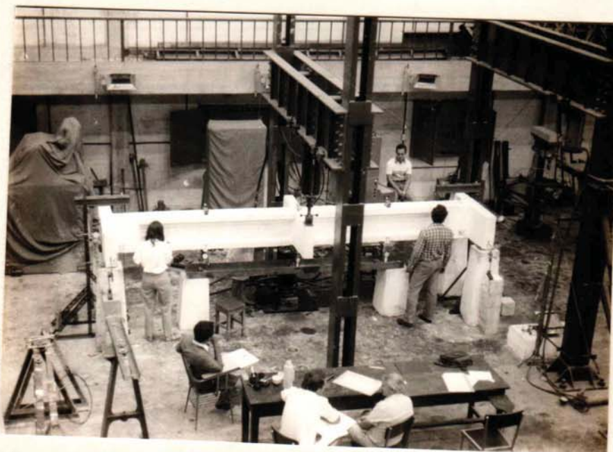
FOT. 4 ENSAYO A TORSION SIMPLE
