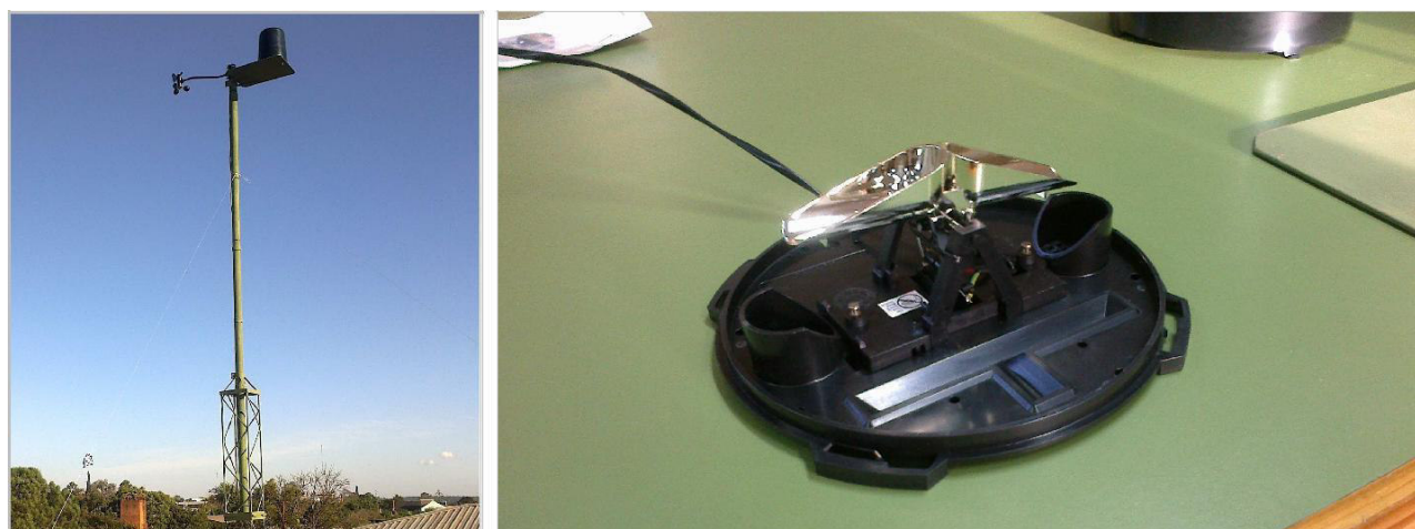
Figuras 3.a: Pluviómetro digital a cangilones (FI-UNaM). Figura 3.b: Estación meteorológica experimental (FI-UNaM).
