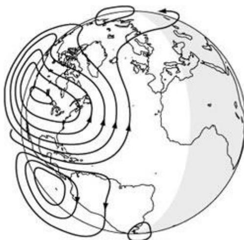
**Figura 3.10.** Diagrama esquemático del sistema de corrientes en la ionosfera del lado de día de la Tierra responsables de la variación Sq. Las flechas indican el sentido en que circulan. [Fuente: <http://www.geomag.bgs.ac.uk/education/earthmag.html>]
