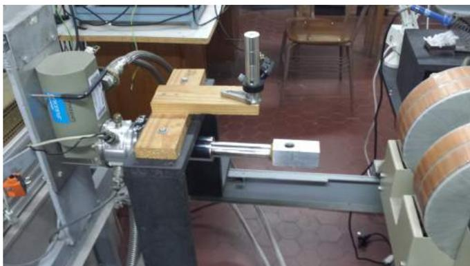
Figura 2.15: Sistema criogénico para mediciones de transporte.
