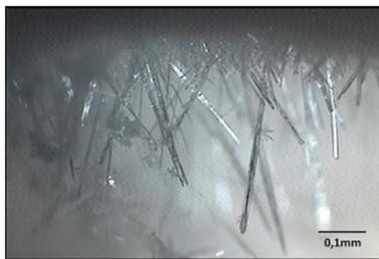
Figura 3.2: Microhilos de ZnO dentro de un ramillete. Aumento 12.5x.
