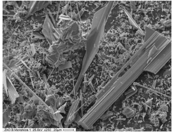
Figura 3.4: Fotografía de microhilo con microscopio SEM donde se puede apreciar la estructura hexagonal del mismo.
