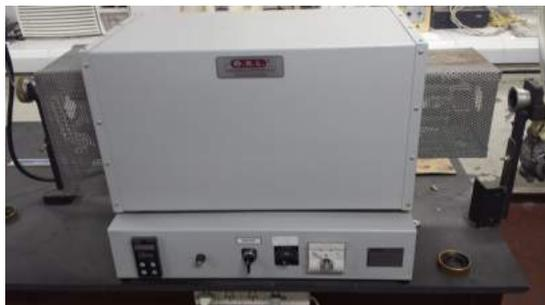
Figura 2.1: Horno eléctrico O.R.L.
