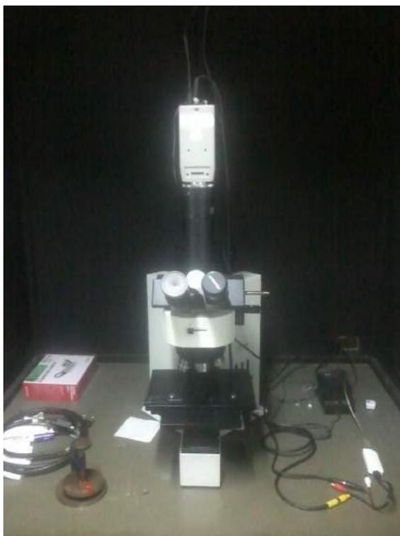
Figura 2.5: Microscopio metalográfico Olympus BX60M. LaFiSo.
