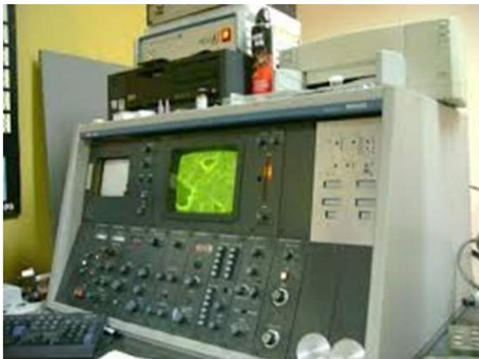
Figura 2.6: Microscopio electrónico de barrido marca Philips SEM 505. CINDECA.
