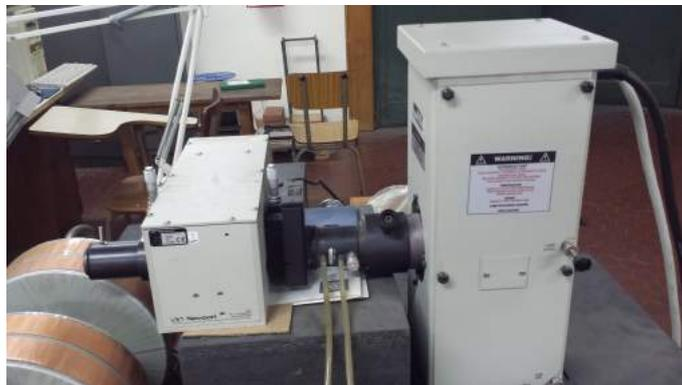
Figura 2.14: A la derecha: lámpara de Xe. A la izquierda: monocromador.
