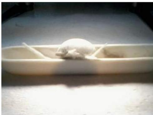
Figura 3.1: Muestra en navcilla de alúmina tal como sale del horno. En el centro se observa el cascarón y a cada lado un ramillete de microhilos.
