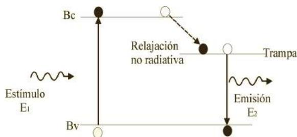
Figura 2.10: Diagrama de bandas esquemático de fotoluminiscencia.
