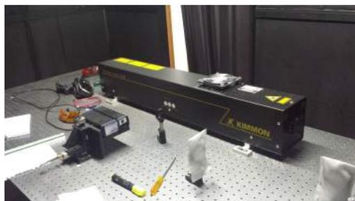
Figura 2.12: Mesa óptica donde se ve el láser de HeCd y el detector.
