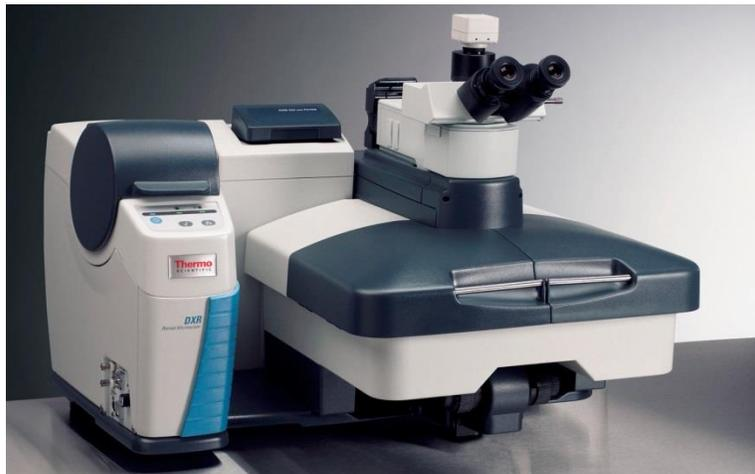
Figura 2.8. Microscopio RamanThermoScientific DXR utilizado durante las mediciones.
