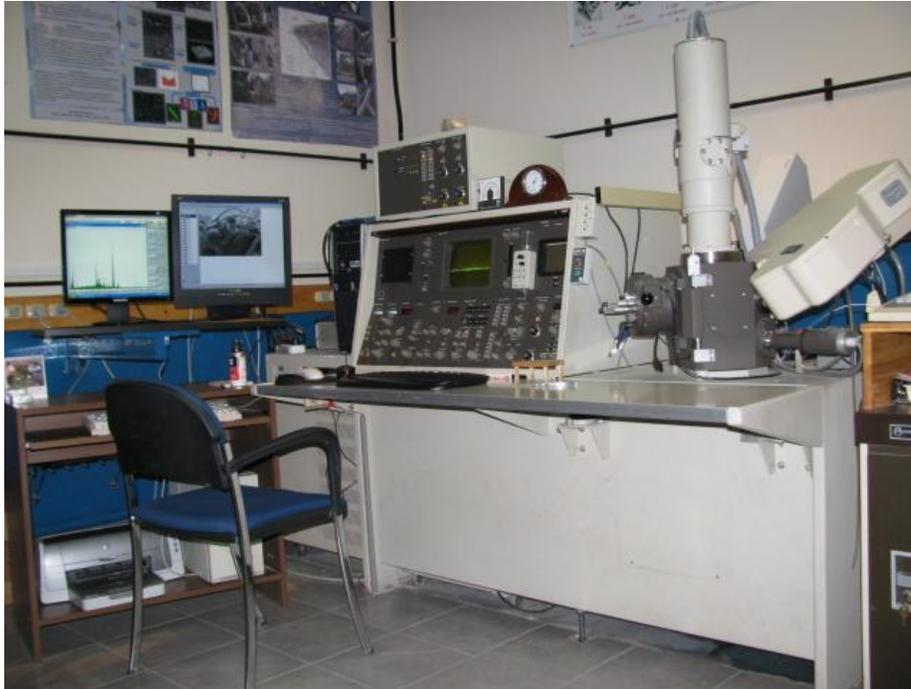
*Figura 2.1. Microscopio electrónico de barrido Philips 515*
