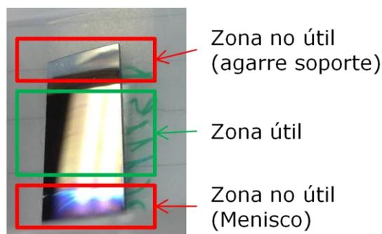
**Figura III.1.2.b** Muestra 261115A en la cual se resaltan la zona útil y las zonas no útiles.
