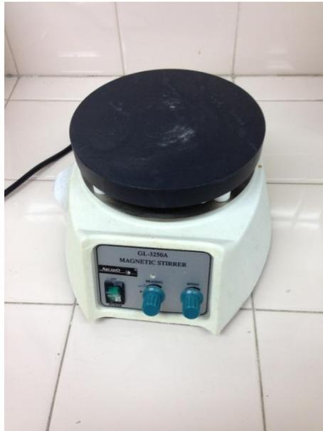
*Figura III.1.1.f. Agitador magnético con placa calefaccionadora marca Arcano Modelo GL-3250A.*
