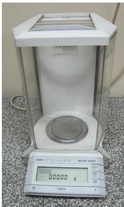
**Figura III.1.1.d.** Balanza utilizada masar los solutos empleados.
