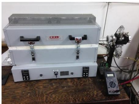
**Figura III.1.2.a** Horno eléctrico ORL-THL/2 Z de LNPD.
