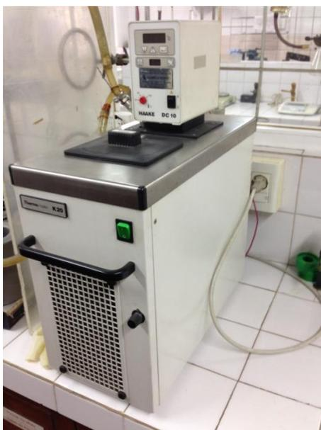
**Figura III.1.1.e.** Yermostato refrigerado Haake DC10-K10 y Termómetro digital CheckTemp HI98509.
