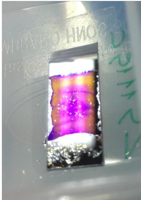
*Figura III.1.2.d* Muestra 251115C después del 2do tratamiento térmico enfriada bruscamente.
