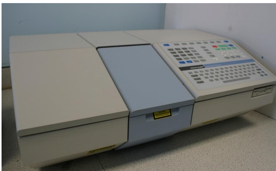
Figura 19 Espectrofotómetro marca Perkin Elmer modelo Spectrum RXI FT-IR.
