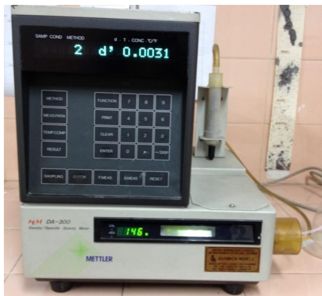
Figura 17. Densímetro de tubo vibrante marca KEM, modelo DA-300.
