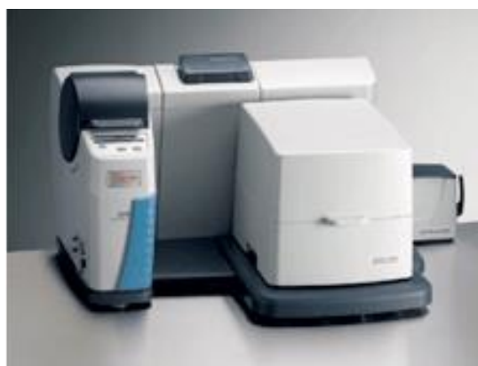
Figura 18 Espectrómetro DXR Smart Raman ThermoScientific
