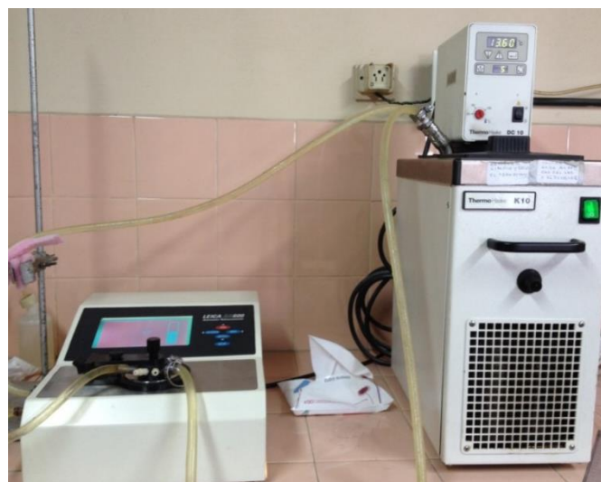
Figura 14 Equipo utilizado para la medición termostatizada del índice de refracción. Refractómetro marca Leica modelo AR600 conectado en serie con un termostato.
