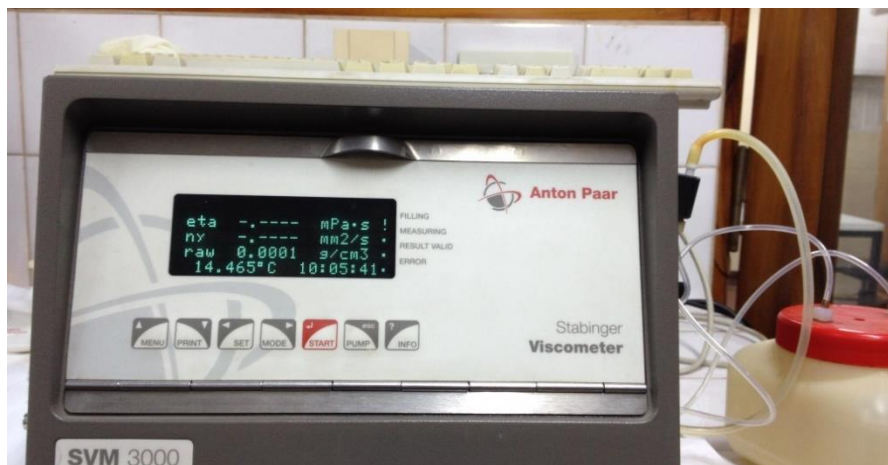
Figura 16 Frente del viscosímetro Anton Para SVM 3000
