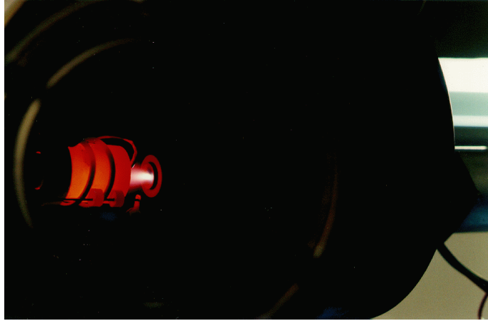
Fig. 3.1: Foto de la pluma obtenida cuando el láser ablaciona sobre el blanco.
