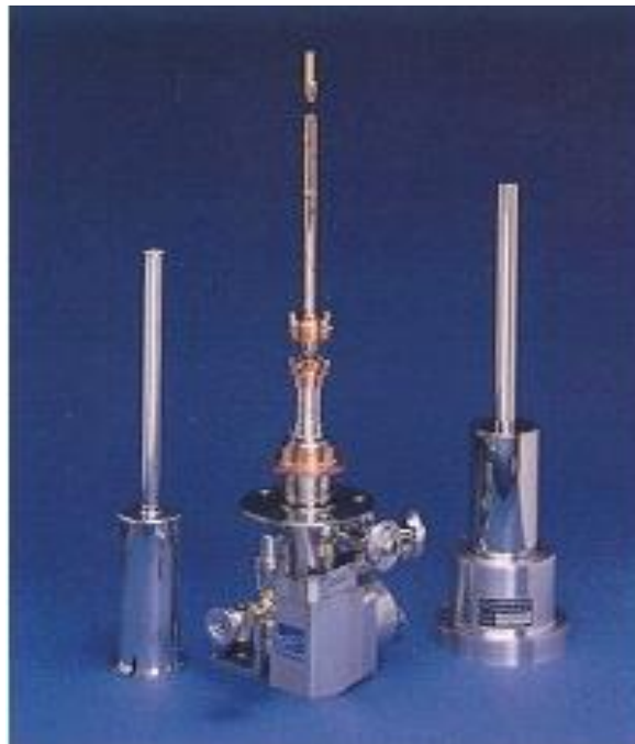
Figura 3.7: En esta figura se observa el cabezal del criogenerador, en el que se colocará la muestra y se realizará la expansión del helio gaseoso para producir una disminución de la temperatura.
