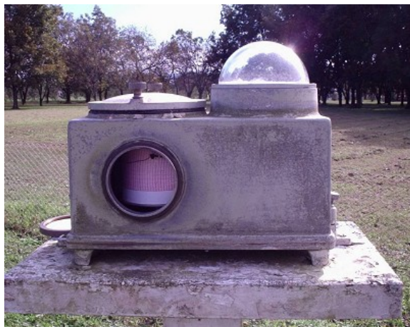
Figura 6.3. Piranómetro de Robitzsch.
