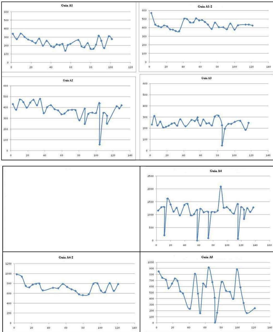
Figura 21. Registro de señal acústica en cada uno de los prototipos de guía acústica.
