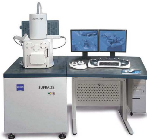
Figura II-5. Equipo SEM usado para la observación de las nanoestructuras.
