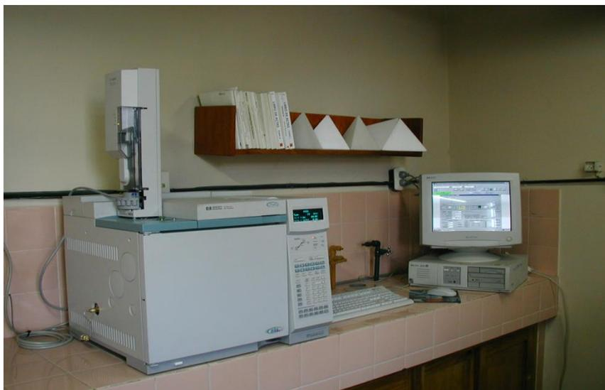
Figura.6.6. Vista de conjunto del sistema cromatografico, mostrando el cromatógrafo en fase gaseosa HP6890, la torreta del inyector automático y la ChemStation acoplada.
