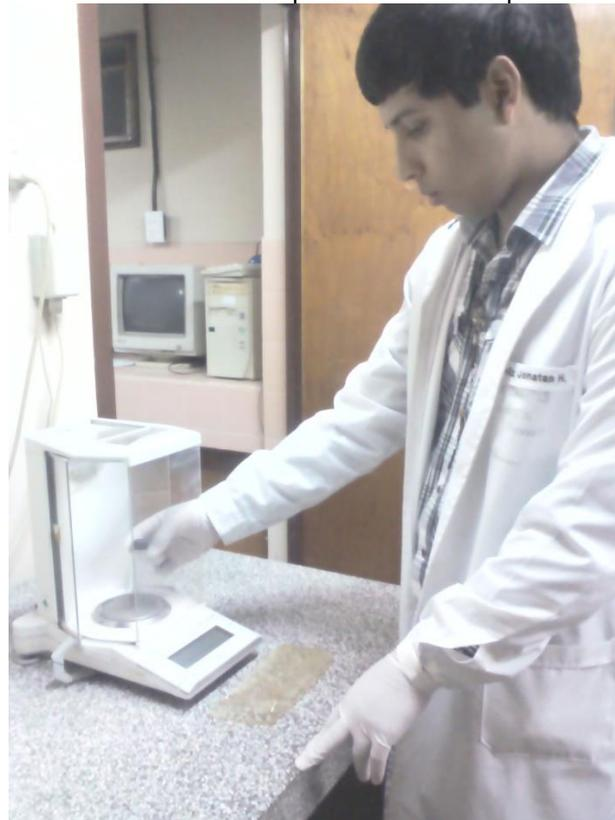
Figura 6.2. Balanza Mettler Toledo, modelo AG-245, con campo dual de pesada.
