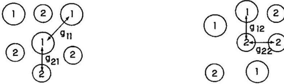
Figura 7.3. Dos tipos de celdas acorde a la teoría de Scott de dos líquidos para mezclas binarias.
