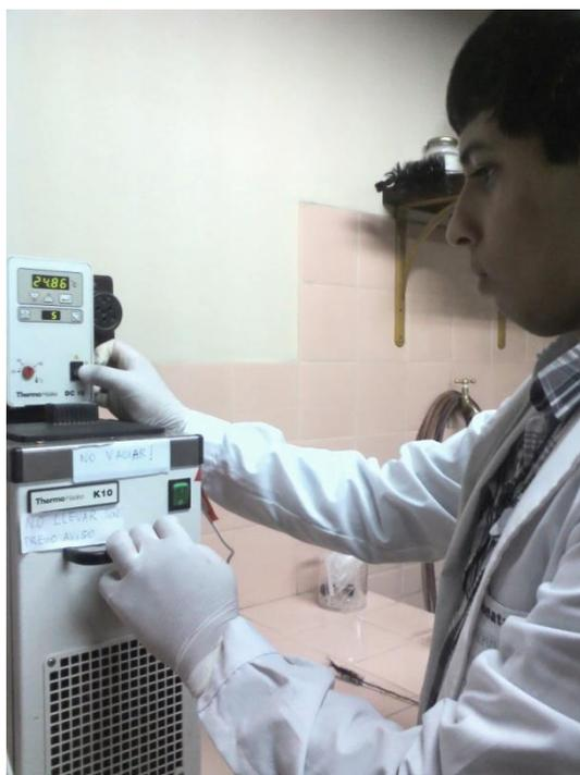
Figura 6.4. Termostato: Haake, modelo K10 con bomba de circulación.
