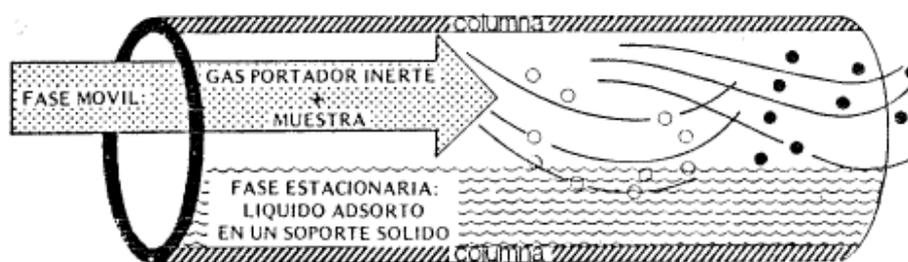
Figura 6.7. Representación esquemática de la columna cromatográfica
