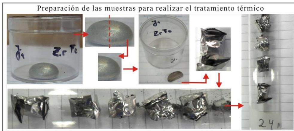
**Figura 4-3:** Secuencia de preparación de muestras para realizar tratamiento térmico. Se toman los botones, se cortan a la mitad, luego se envuelven en láminas de tantalio y finalmente se colocan dentro del tubo de vidrio de sílice y se sella.
