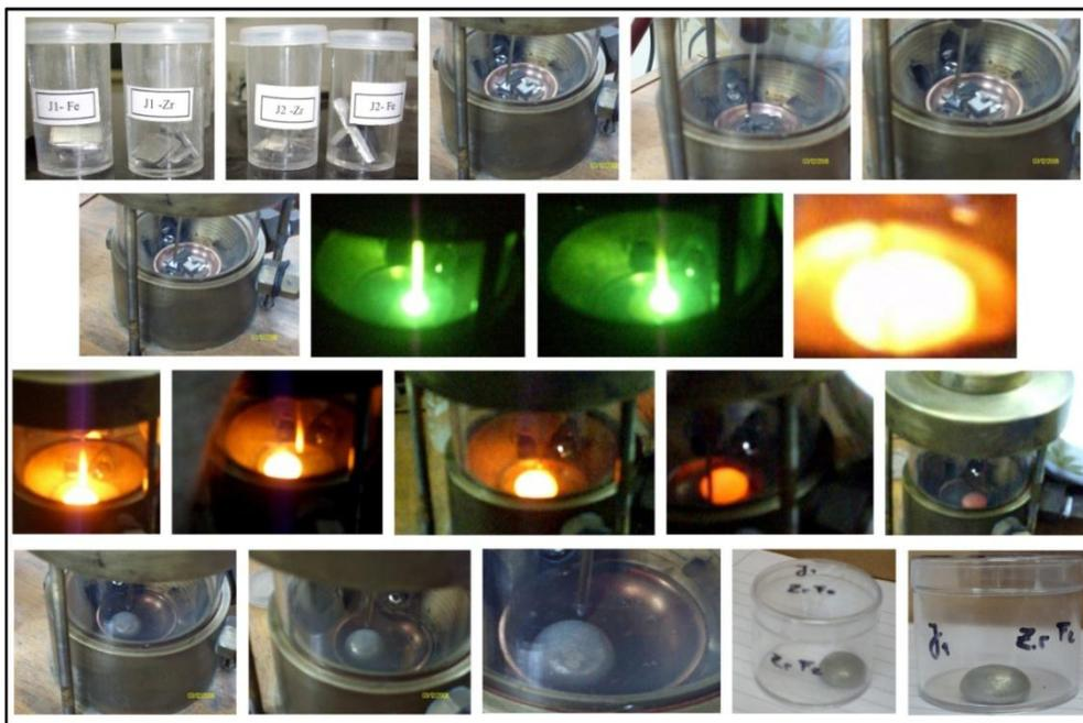
Figura 4-2.b: Proceso de fabricación de las aleaciones. Los materiales de partida se colocan dentro del horno de arco y se funden hasta obtener los botones.
