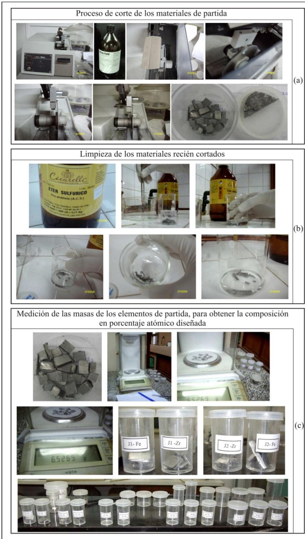
**Figura 4-1:** Secuencia de preparación de los materiales de partida. (a): Corte de los materiales de partida con cortadora con disco de diamante. (b): Limpieza con éter de los trozos recién cortados. (c): Pesada. Materiales constitutivos listos para fundir.
