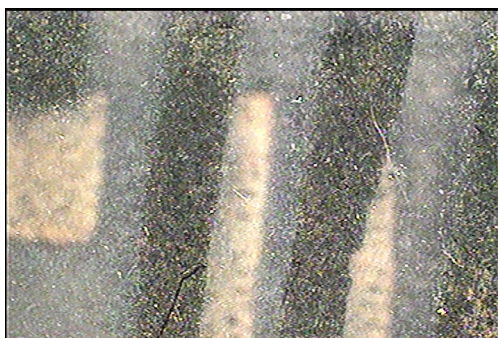
Figura 3.1: Cristal de SrTiO 3 . Como se observa, las muestras son traslúcidas a la luz visible. Las zonas oscuras corresponden a las pistas depositadas de oro, realizadas en ambas caras planas. Figura tomada con microscopio metalográfico; aumento 12,5X.
