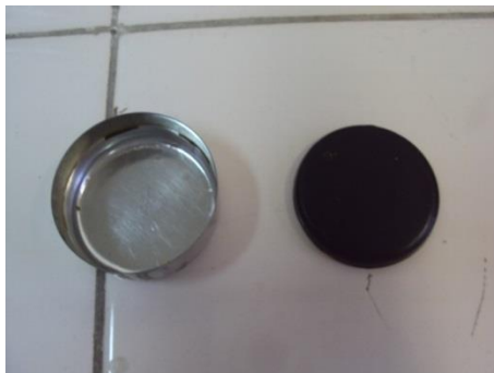
Figura V.11 Fotografía de la muestra de cera de cutícula y el molde utilizado para hacerla
