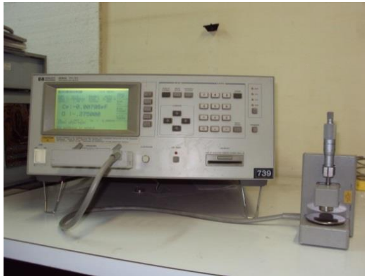
Figura V.1 HP 4284 APrecision LCR Meter con la celda HP16451B para sólidos
