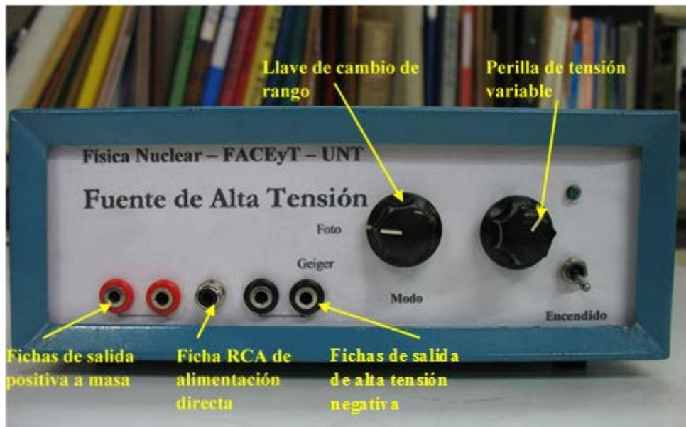
Figura 5.7: Vista del frente de la Fuente de Alta Tensión y sus controles analógicos.
