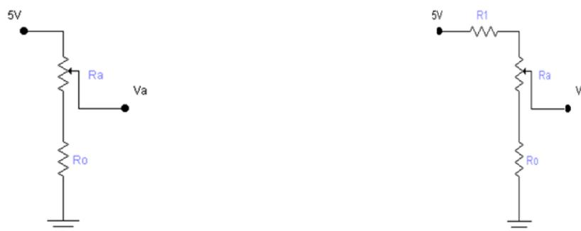
**Circuito 10:** Esquema Inicial y Modificado para el ajuste de los rangos de tensión buscados.
