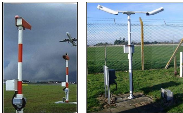
Figura 2.2 - Transmisómetro (izquierda, AEMET) y escaterómetro (derecha, fuente: Met Office).
