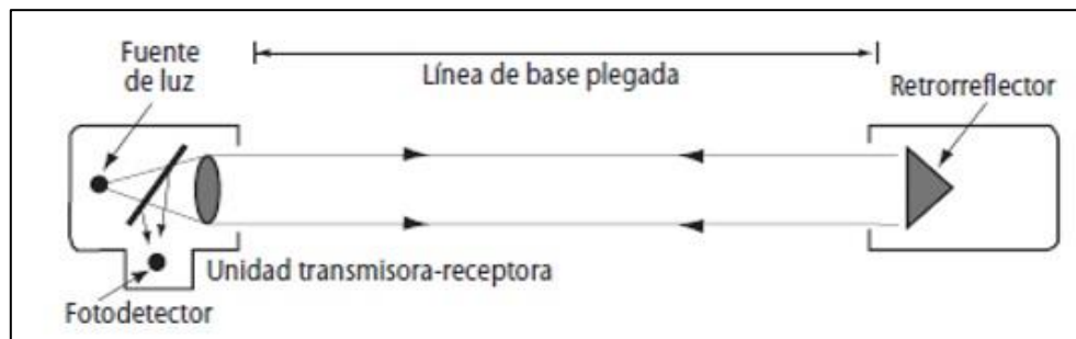
Figura 2.5 - Transmisómetro de un solo extremo.
