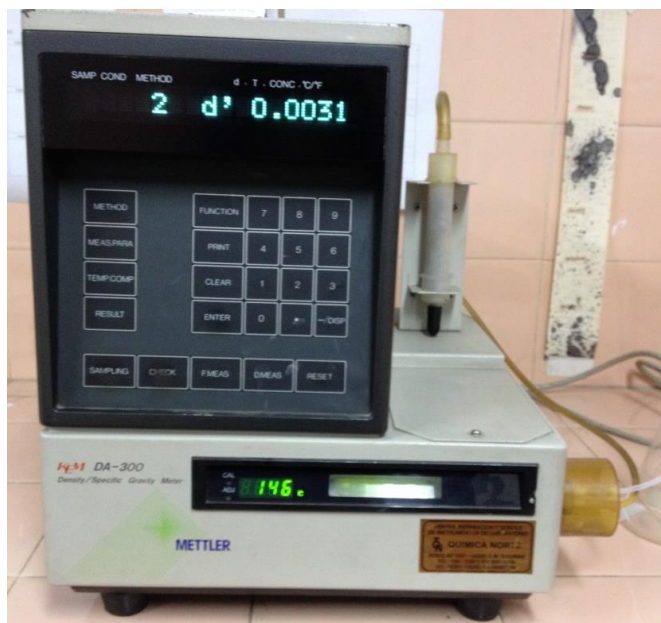
Figura 15. Densímetro de tubo vibrante marca KEM, modelo DA-300.
