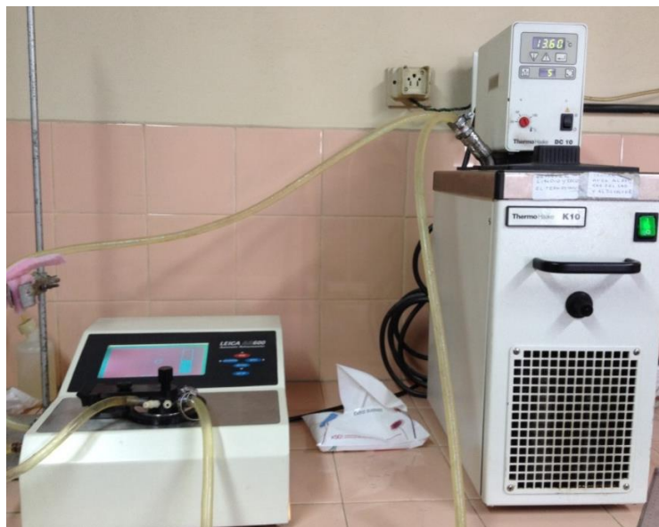
Figura 12. Equipo utilizado para la medición termostataza del índice de refracción. Refractómetro marca Leica modelo AR600 conectado en serie con un termostato.
