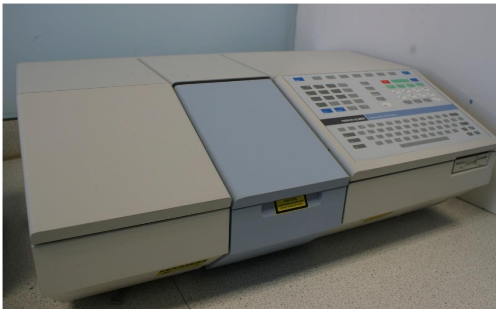
Figura 189. Espectrofotómetro marca Perkin Elmer modelo Spectrum RXI FT-IR.
