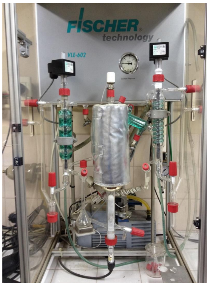
Figura 201. Equipo para la determinación del ELV
