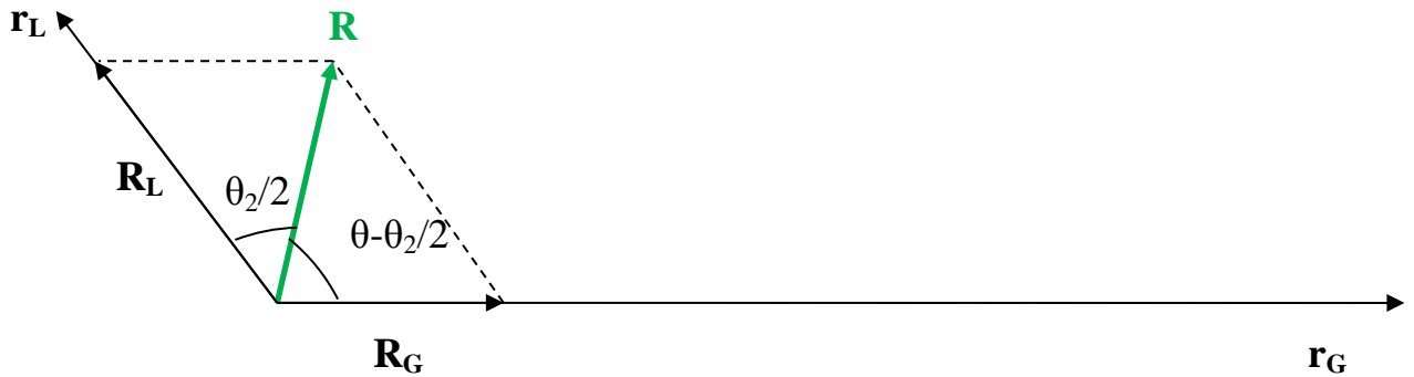
Figura 6.9: Descomposición del vector R en las direcciones de r_L y r_G .
