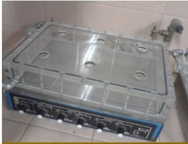
Figura 11. Agitador magnético de 6 canales.
