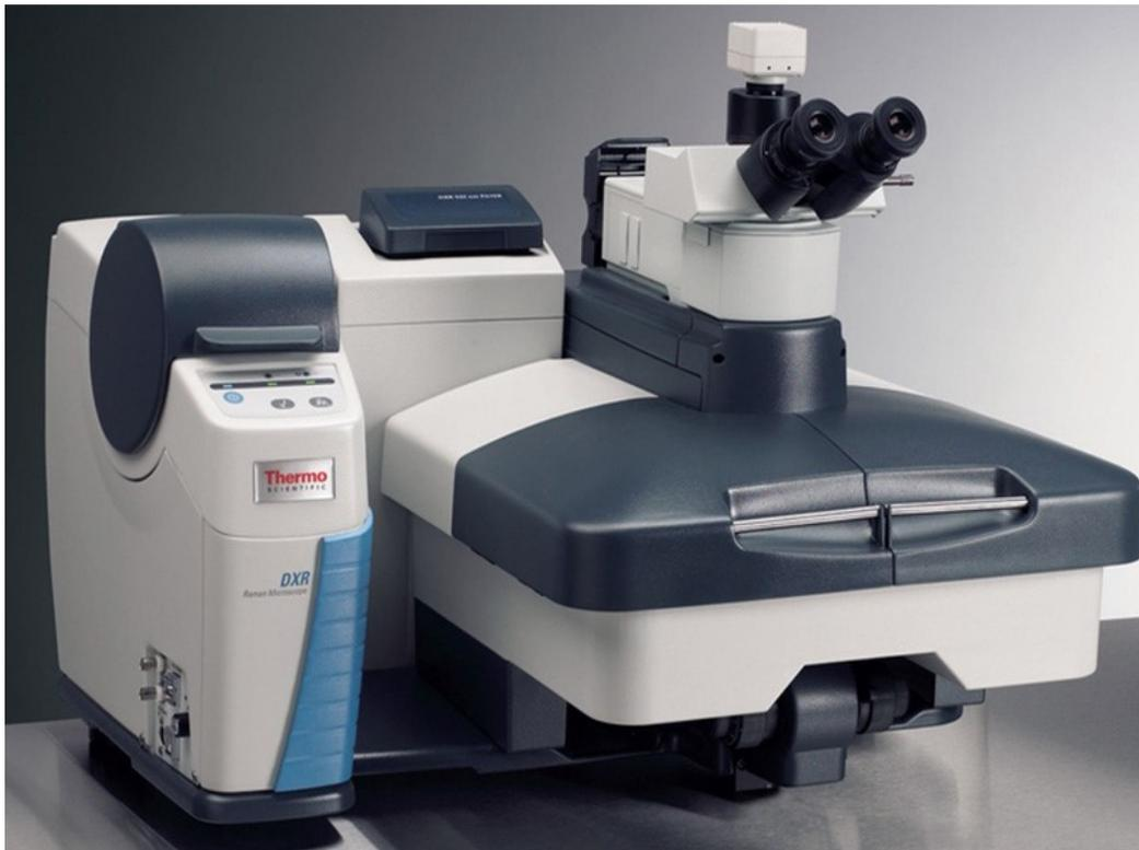
Figura 13.- Microscopio Raman.
