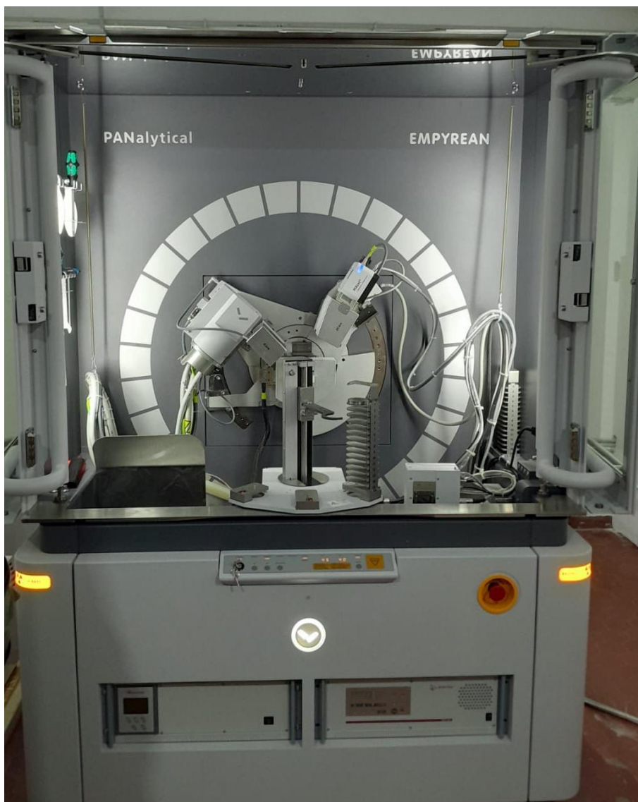
Figura 2.7. Difractómetro de rayos X Empyrean (Malvern Panalytical) en el LINARX, en la Universidad Nacional de Tucumán.
