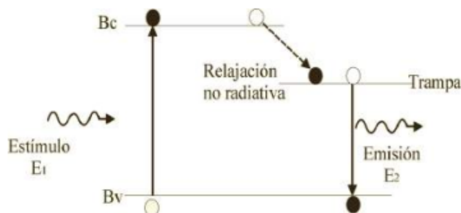
Figura 2.2: Proceso de fotoluminiscencia, con recombinación no radiativa y recombinación a través de una trampa.
