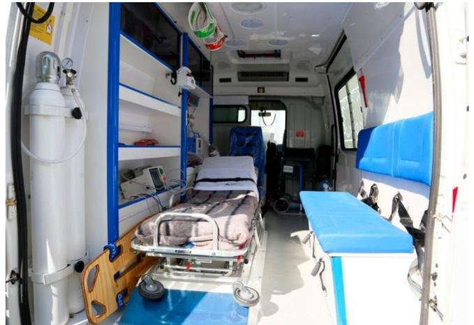
Fig. 9: Interior de una ambulancia con camilla móvil y portátil, silla de ruedas, asiento tipo butaca, baulera, AA, ventilador, etc.
