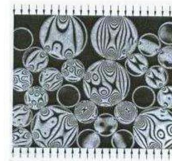
Figura 4.4: Transferencia de carga entre agregados de hormigón. Modelo de Wischers y Lusche.
