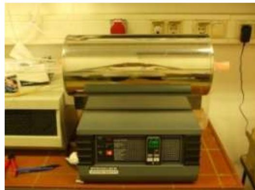
**Fig. 7.22** Horno tubular. En esta foto el dispositivo empleado para el crecimiento de las muestras
