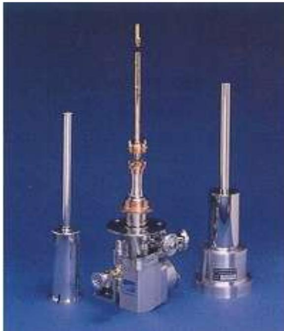
**Figura 3.5** En esta figura se observa el cabezal del criogenerador, en el que se colocará la muestra y se realizará la expansión del helio gaseoso para producir una disminución de la temperatura.
