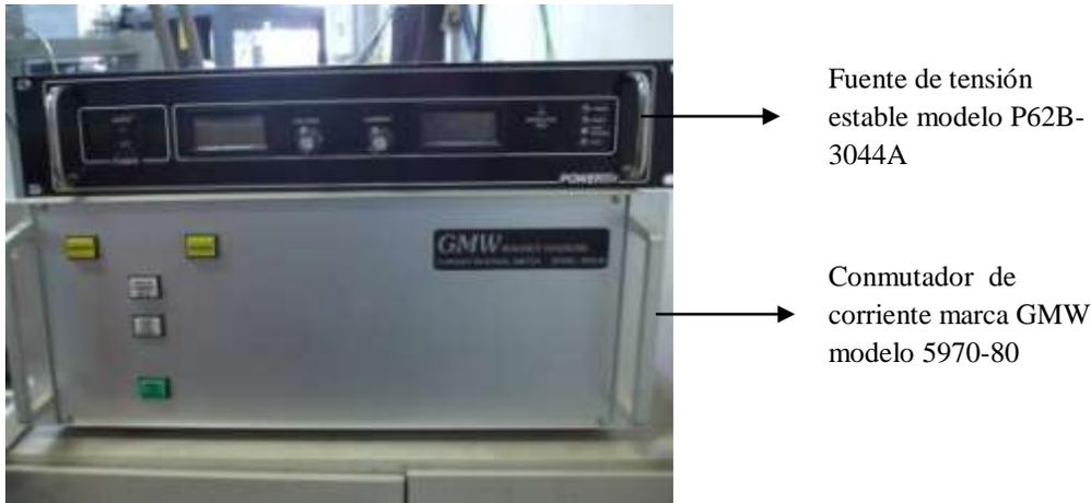
**Fig. 3.10** Conmutador de inversión de corriente marca GMW modelo y 5970-80 y fuente de tensión estable modelo P62B-3066A
