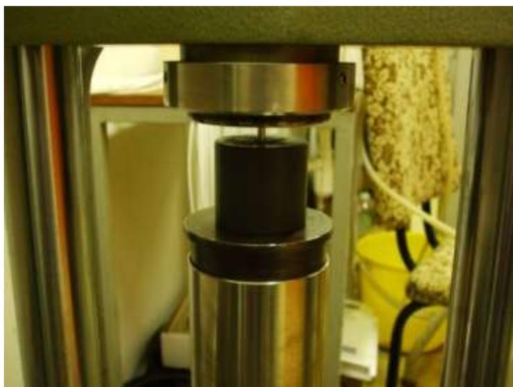
**Fig. 7.19** Fotografía del molde empleado para prensar los polvos fuentes junto a la prensa hidráulica durante un proceso de compresión
