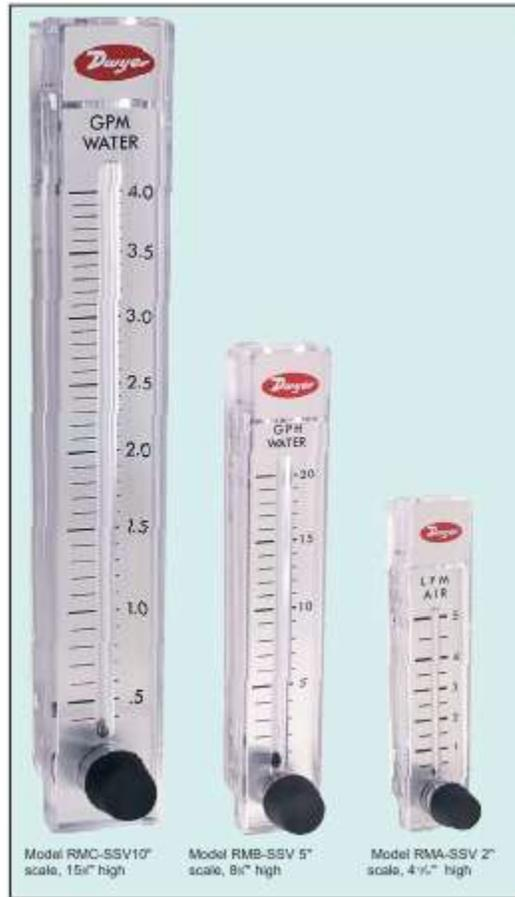
**Fig. 5.7.** Fotografía de los caudalímetros de área variable de la empresa Dwyer
