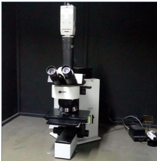
Figura 2.14. Fotografía del microscopio óptico OLYMPUS, modelo BX-60M, utilizado en este trabajo. Ubicación: Laboratorio de Física del Sólido, FaCEyT, Universidad Nacional de Tucumán.
