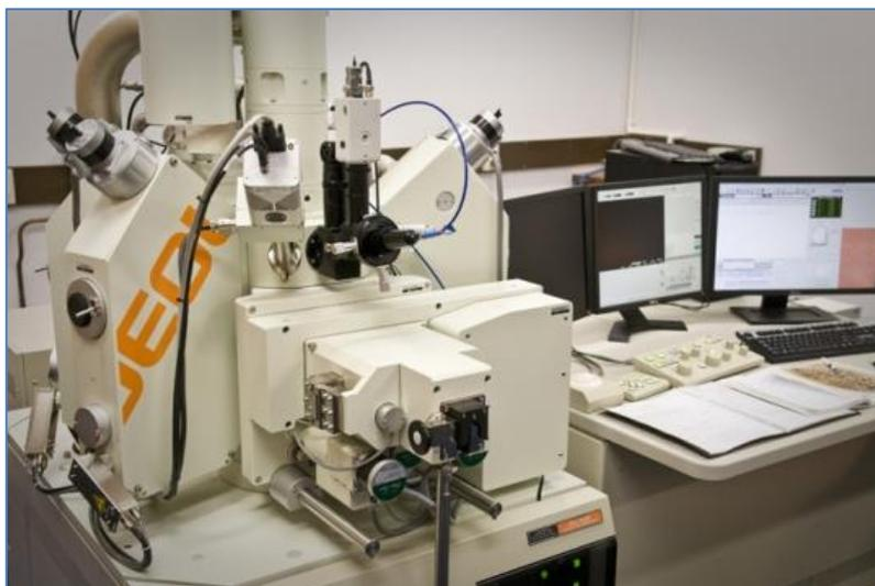
Figura 2.12. Fotografía de la microsonda JEOL, modelo JXA-8230, utilizada en este trabajo.
