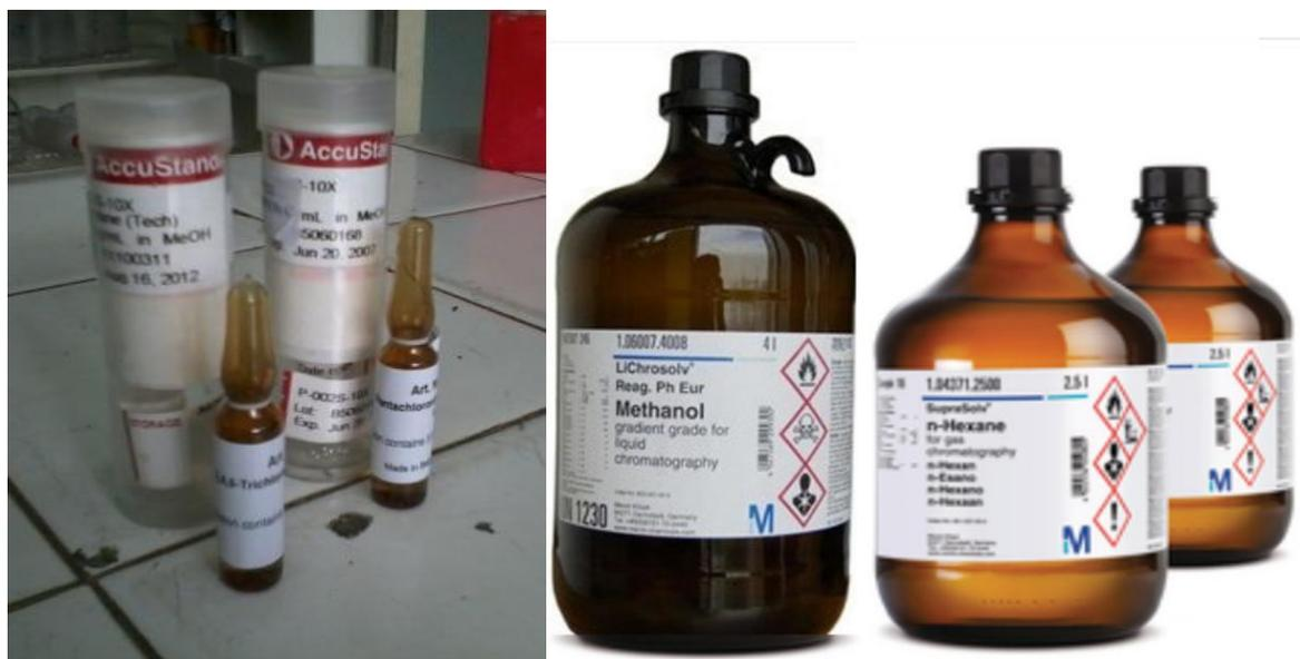
Figura 2.11- Material de Referencia Certificado marca AccuStandar usado como patrones y solventes Merck: Metanol, n-Hexano y agua cromatográfica.
