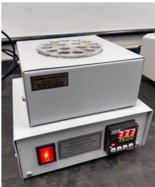
Figura 2.13. Termoreactor DQO. Modelo TR-105
