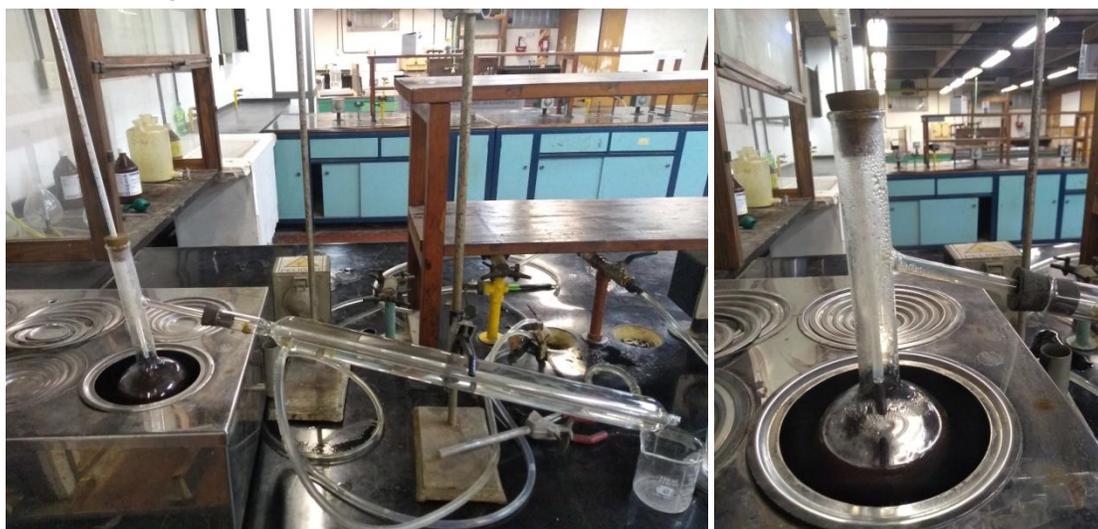
Figura 4.3 - Concentración de vinazas, equipo de evaporación en escala laboratorio.
