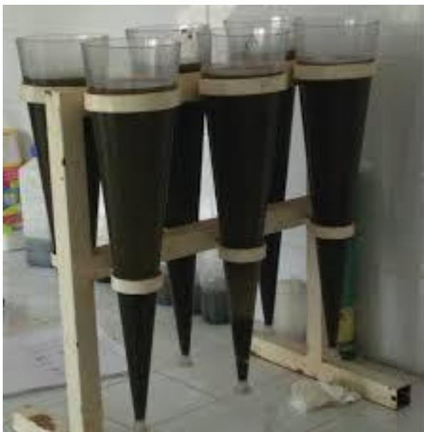
Figura 2.16- Determinación de Sólidos Sedimentables en cono de Imhoff.
