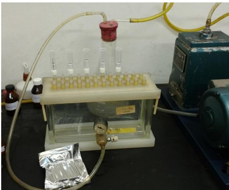
Figura 6.1- Pretratamiento de las soluciones acuosas de plaguicidas organoclorados por extracción en fase sólida (SPE).
