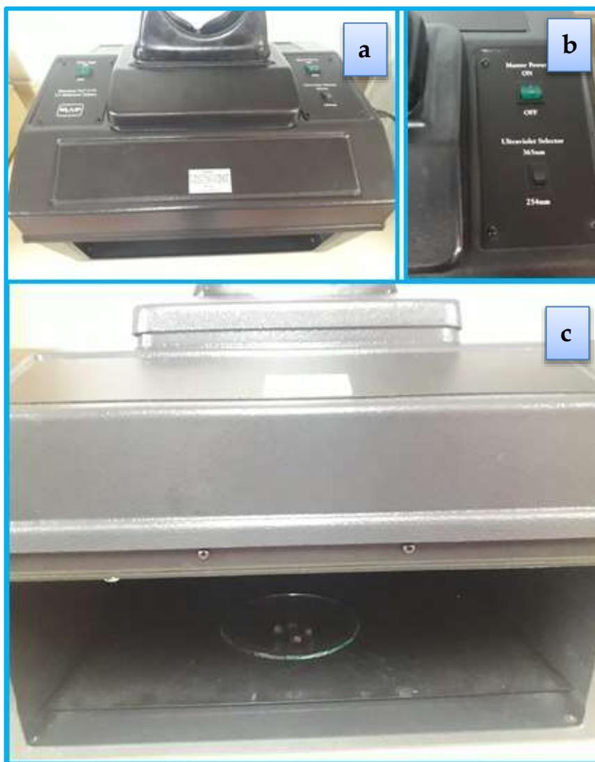
Figura 3. 8. a. Equipo utilizado para la irradiación de los frutos arándanos a nivel laboratorio. b. Interruptores de control para la selección de las distintas longitudes de onda UV o la luz blanca superior del interior. c. Frutos arándanos a ser tratados.
