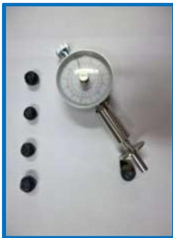
Fig. 5.18. Esclerómetro-penetrómetro utilizado para medir dureza
