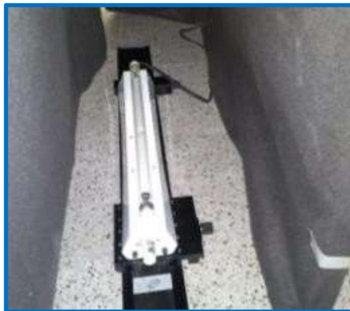
Figura 5.4. Lámpara OSRAM Germicidal Puritec - HNS 15W G13 - G15T8/OF (Lámpara UV)
