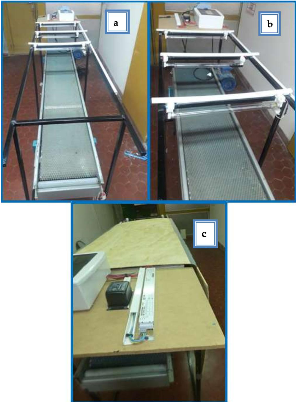
Fig. 5.3. Prototipo propuesto. a\_ Cinta transportadora y estructura de cámara. b\_ Lámparas sobre estructura de cámaras. c\_ Cubierta de madera sobre estructura metálica.
