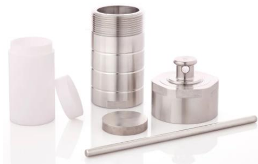
Fig.4. Sistema hidrotermal empleado para la síntesis. El recipiente donde se realiza la síntesis permanece cerrado durante la síntesis y a lo largo del proceso de enfriamiento. (Figura obtenida de internet https://www.amazon.com/-/es/autoclave-hidrot%C3%A9rmica-digesti%C3%B3n-recipiente-laboratorio/dp/B07KKBS9X6 ).
