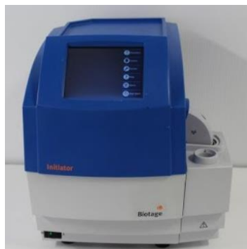
Fig.5. Equipo marca Biotage Initiator Plus empleado para la síntesis hidrotermal asistida con microondas de nanoestructuras de ZnO.
