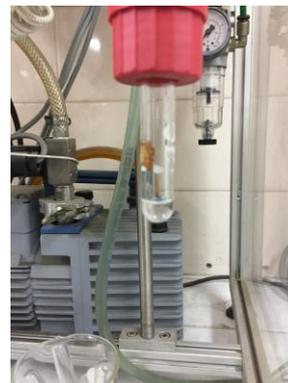
*Figura 6.14. Fotos del sistema Butilamina (1) + MIK (2) en las determinaciones de ELV. a) fase vapor; b) equipo ELV; c) fase líquida. En las tres fotos se observa claramente la separación de fases.*
