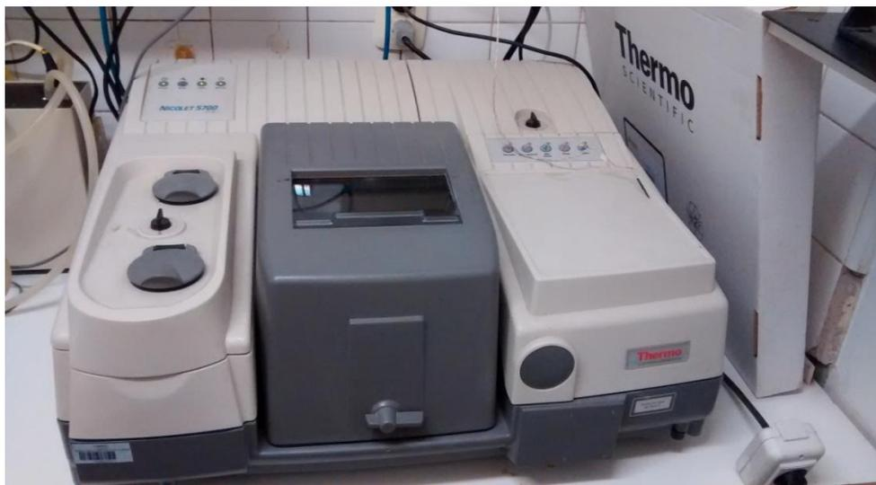
Figura 4.5.-. Espectrofotómetro FT IR Nicolet 5700
