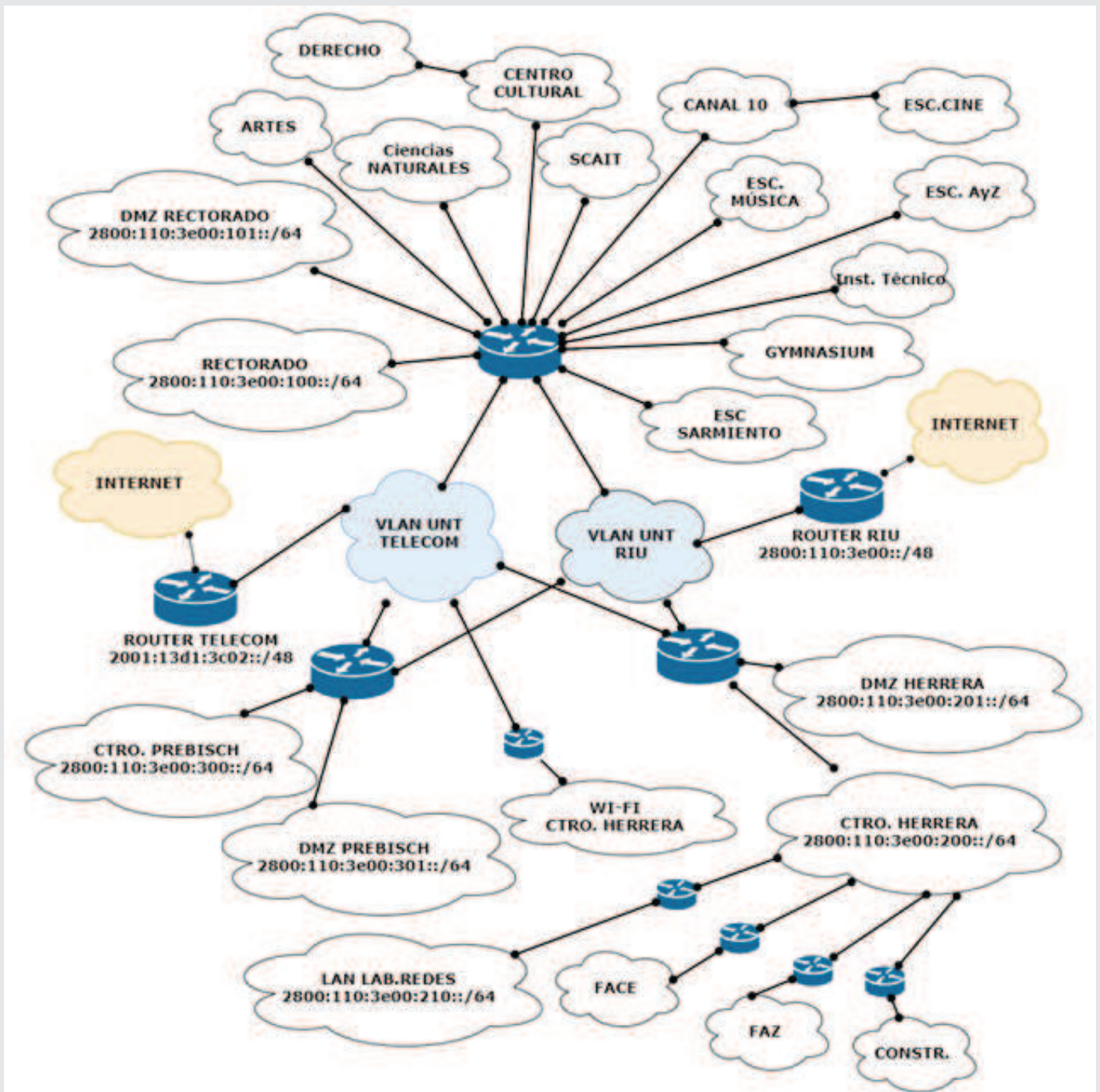
Fig. 8 Diagrama general de la red UNT con direccionamiento IPv6.
