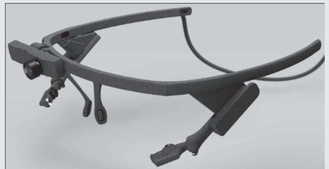
Fig. 1 *Pupil Eyetracker Core* - marco y cámaras. Imagen pública tomada de <https://pupil-labs.com/products/core/>
